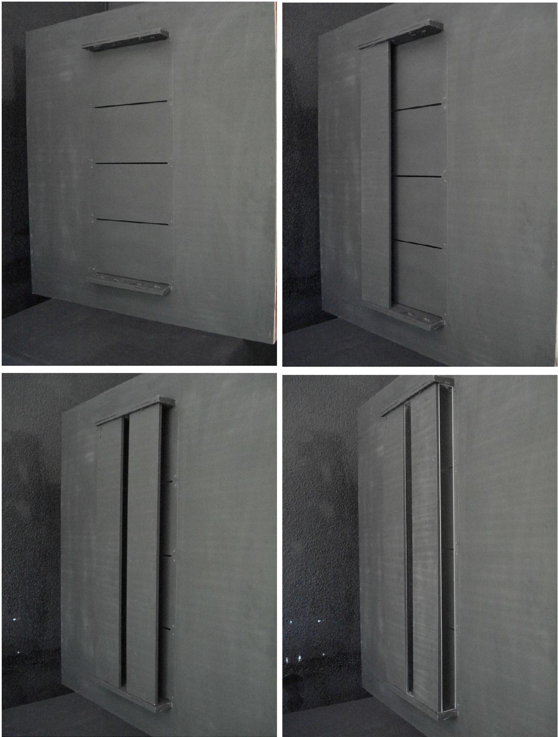
*Figura 3.15 Secuencia de montaje del modelo de fachada ventilada con juntas abiertas*
