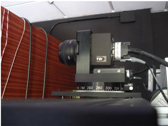
*Figura 3.18. Imagen de la cámara CCD*
