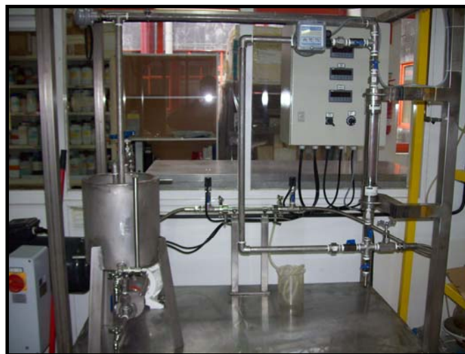
Figura 5.4. Fotografía del equipo de emulsificación a escala piloto
