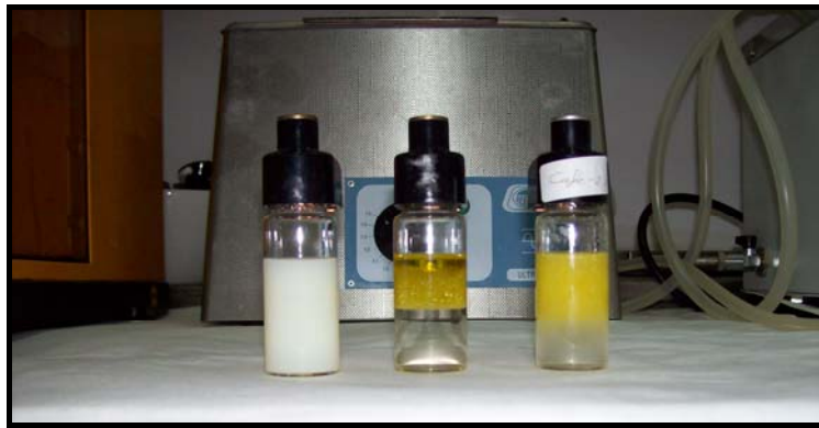
Figura 2.3. Fotografía de tres emulsiones, una estable (color blanco) y dos desestabilizadas
