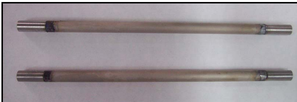
Figura 4.43. Fotografía de dos membranas tubulares metálicas para emulsificación con tamaños de poro de 5 y 10 \mu\text{m}
