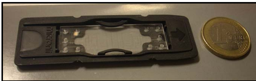
Figura 6.16 Fotografía de uno de los microchips utilizados en los experimentos de adsorción capa a capa (ACC)
