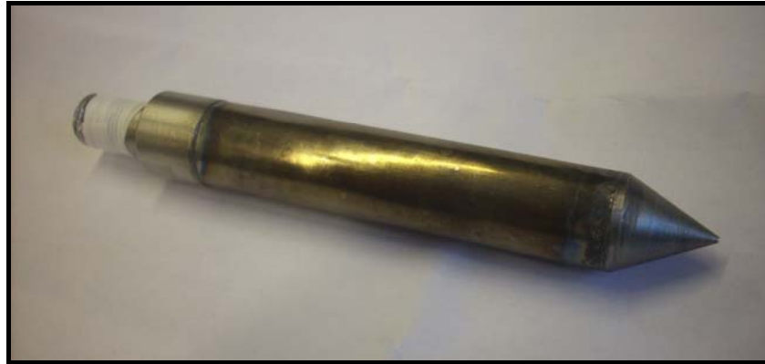
Figura 6.1. Membrana tubular metálica oscilante, tipo vela, utilizada en la preparación de partículas de sílice
