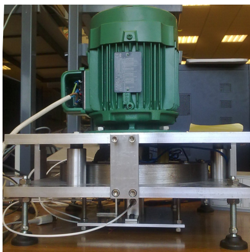
Figura 7.2: Disposición del rotor y unión al motor de inducción.
