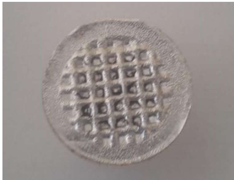
Figura 81. Detalle del parrillado de la tapa de aluminio resultante tras la prueba en vacío.
