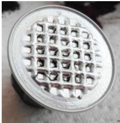
Figura 31. Imagen de los relieves sobre la tapa inferior de aluminio, una de las modificaciones de la cápsula inicial.
