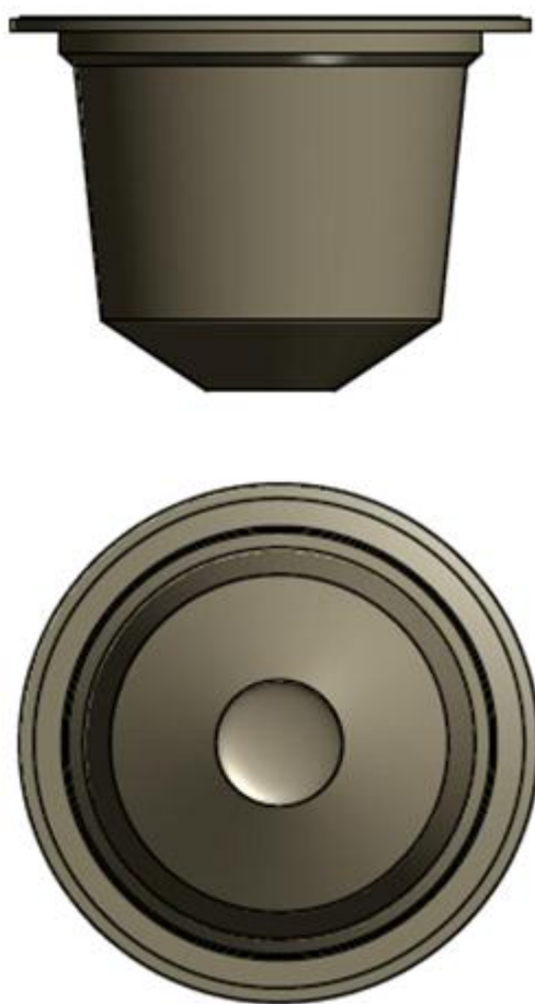
Figura 45. Alzado y planta de la cápsula de Ethical Coffee. [ETH12]
