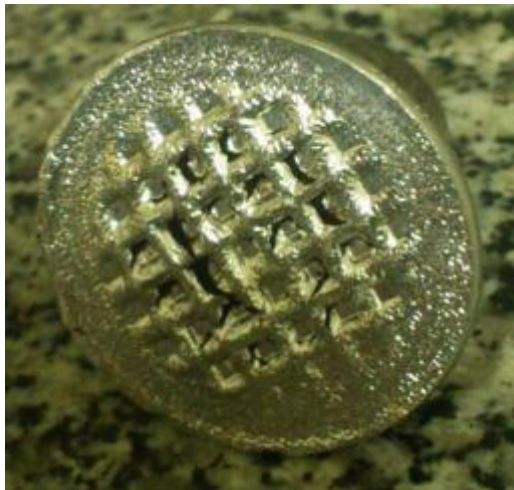
Figura 87. Imagen del parrillado originado por el sistema de sellado en una de las cápsulas de las catas.
