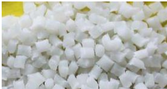
Figura 76. Detalle de la PA 2200 antes de la termoconformación. [EOS12]
