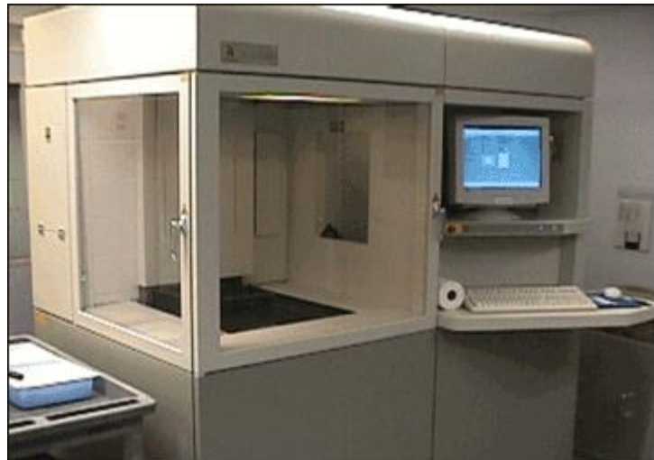
Figura 77. Imagen de la máquina SLA 5000 utilizada en la fabricación de los prototipos. []
