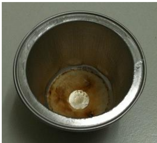
Figura 33. Imagen de la válvula de papel instalada en las cápsulas Nespresso siguiendo la patente [US7658141] de 2.006.
