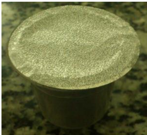
Figura 85. Imagen de la cápsula cargada y sellada antes de la erogación.
