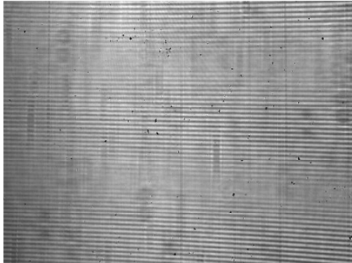
Figura 5.7: Patrón de interferencia obtenido del montaje con iluminación de doble longitud de onda.
