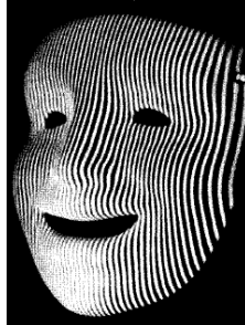
Figura 2.5: Ejemplo de curvas de contorno de Moiré.
