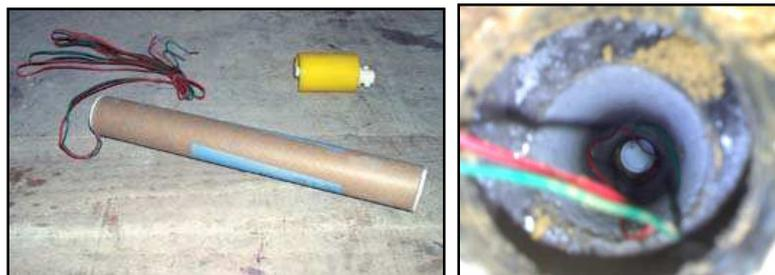
**Figura 5.13.- Sistema de presión de gas direccional**
