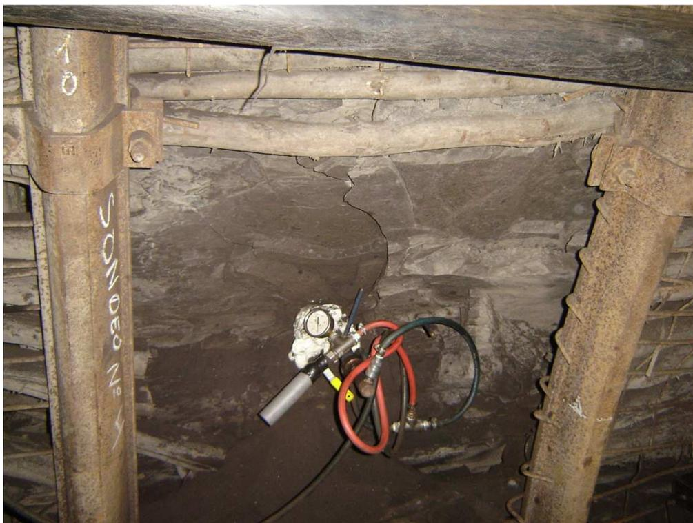
**Figura 15.** Sondeo sellado con lanza y equipo de medida de presión
