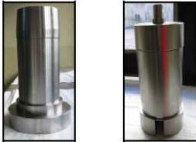
**Figura 17.** Tomamuestras en su modalidad de extracción (izquierda) y ensayo (derecha).
