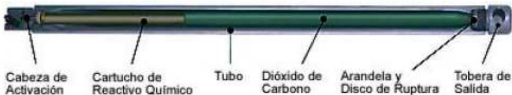
Figura 4.19.- Esquema de una cánula CARDOX
