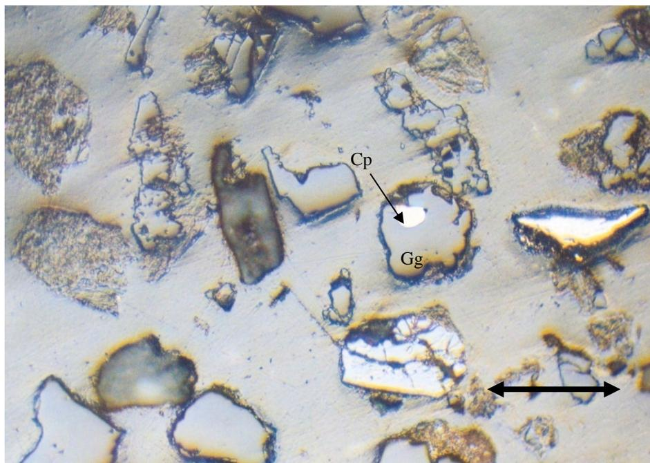
**Figura 4-10:** Muestra de sulfuros primarios del yacimiento Bajo de la Alumbraera. Microfotografía de una partícula de ganga (Gg) con una inclusión de calcopirita (Cp). Objetivo 16x. Escala 100  $\mu\text{m}$ .
