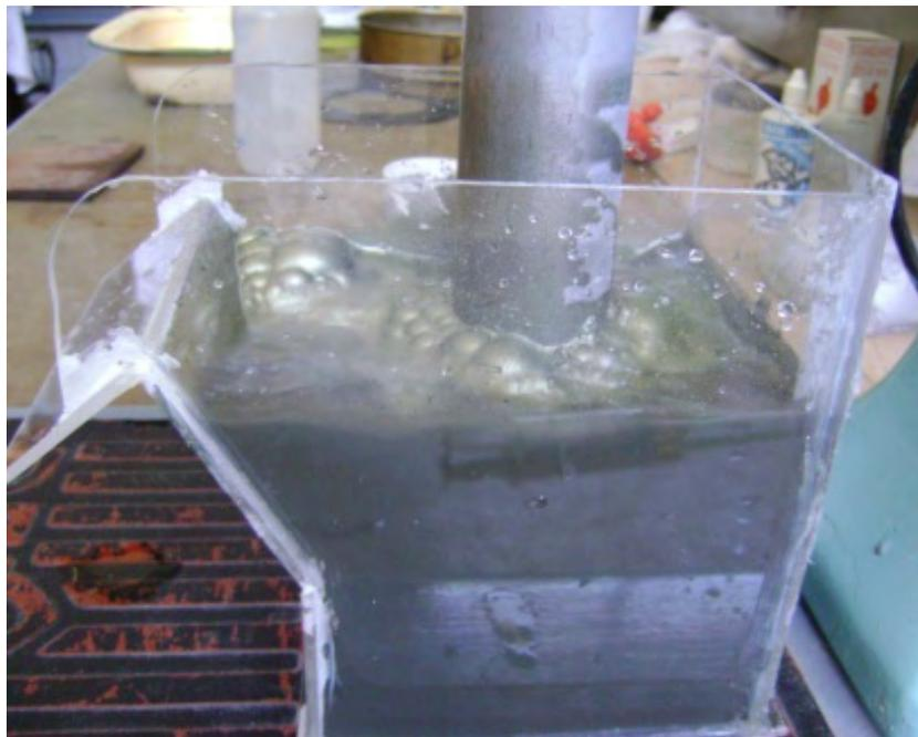
**Figura 4-32: Celda de flotación con recipiente de 2 litros**
