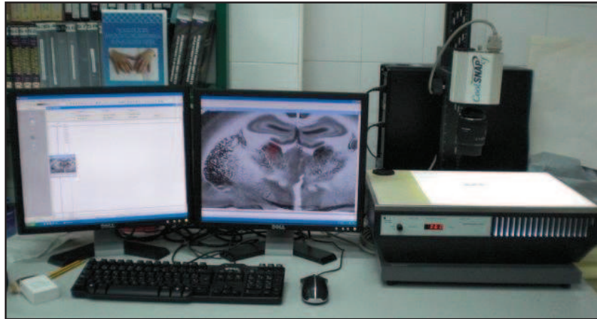
Figura 12: Fotografía en la que se muestra el sistema de análisis de imágenes informatizado. A la izquierda se encuentra la pantalla del ordenador donde se observa ampliada la sección elegida y a la derecha se localiza la fuente de luz, conectada a la cámara de alta sensibilidad, donde se coloca el portaobjetos que se pretende cuantificar.
