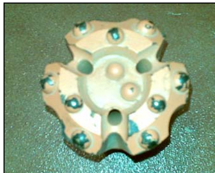
Ilustración 58: Muestra A11BR-DC. Obsérvese el sector central hundido respecto de plano frontal de la boca, con dos botones frontales incluso y la comunicación directa entre el frente hundido y los canales de barrido (fotografía del autor)
