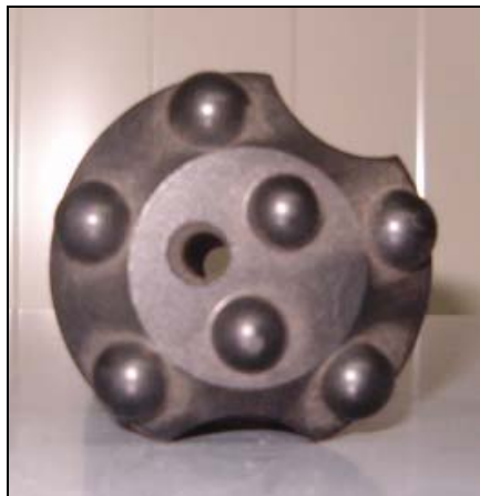
Ilustración 40: Boca fabricada por Boart Longyear en disposición 5+2 con botón hemisférico (fotografía del autor)
