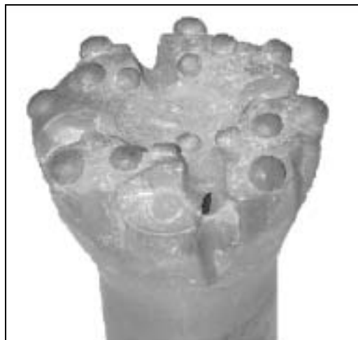
Ilustración 26: Boca con desgaste debido a fallos macroscópicos. Obsérvese los daños en la matriz e incluso la pérdida de botones. (Fotografía cortesía de Jack McGrath - Boart Longyear)
