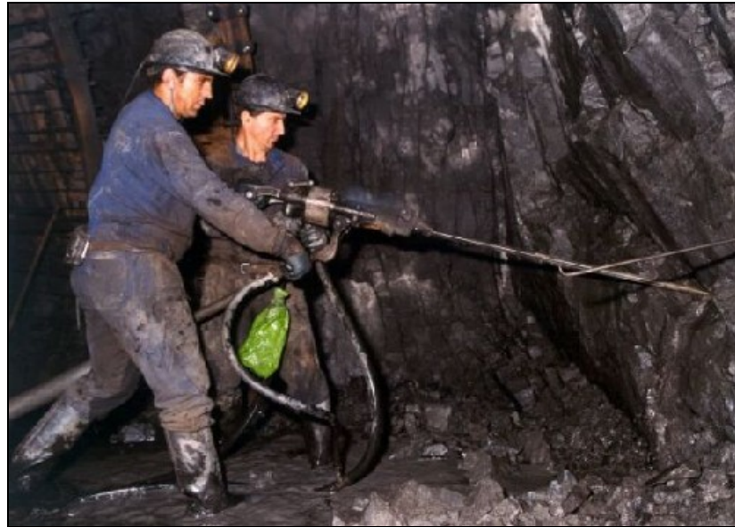
Ilustración 13: Barrenistas perforando con martillo manual neumático, con columna empujadora también neumática.
