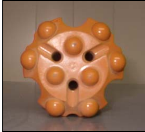
Ilustración 44: Boca de Boart Longyear 6+3 en botón redondo (fotografía del autor)
