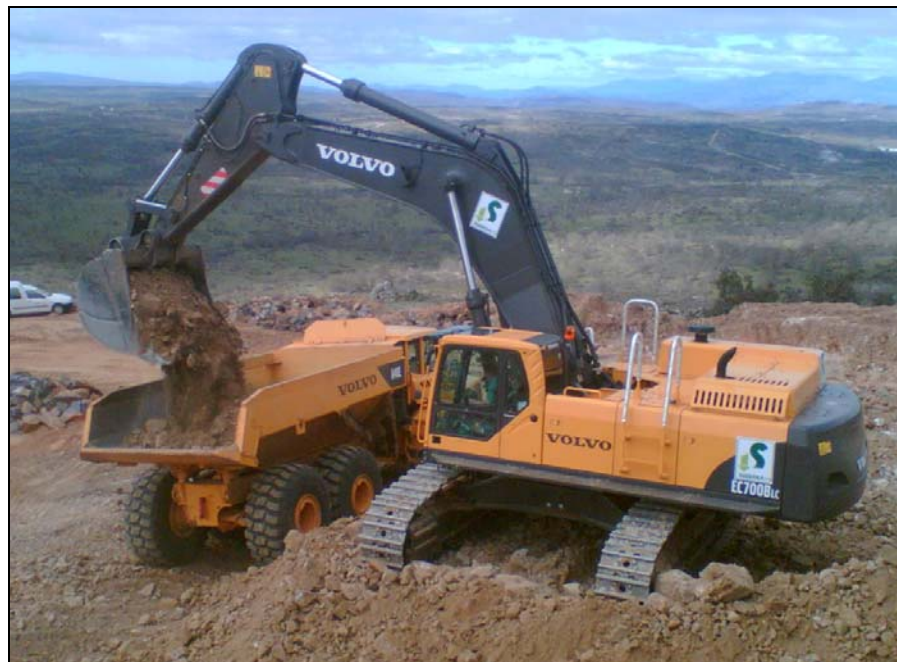
Ilustración 53: Retroexcavadora Volvo EC700B cargando sobre volquetes articulados Volvo A40E (Fotografía del autor)
