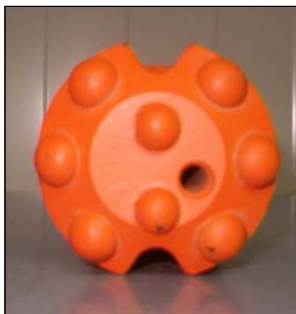
Ilustración 45: Boca fabricada por Secoroc en disposición 6+2 con botones hemisféricos (fotografía del autor)
