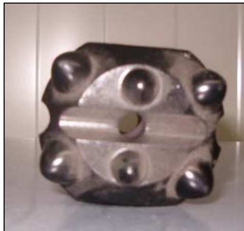
Ilustración 43: Boca fabricada por Boart Longyear en disposición 4+2 con botón parabólico (fotografía del autor)
