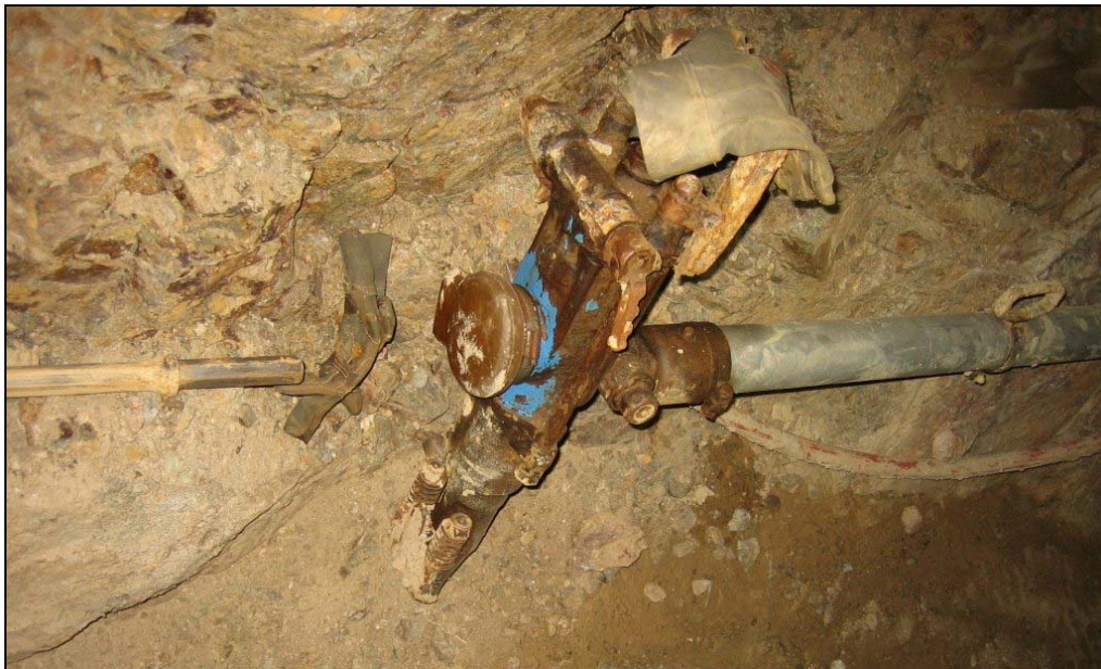
Ilustración 23: Martillo neumático de perforación acoplado a empujador de columna neumática.
