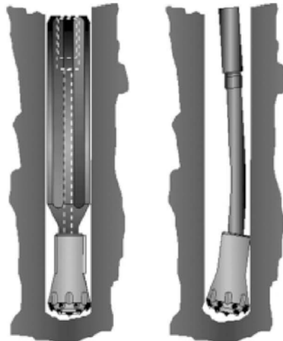
Figura 5: Accesorio centrador (izquierda) para evitar desviaciones del varillaje como la representada en la derecha.
