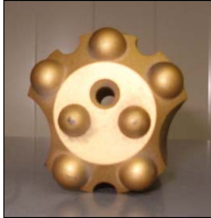
Ilustración 49: Boca fabricada por Sandvik en disposición 5+2 con botones hemisféricos (fotografía del autor)
