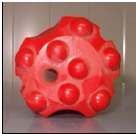
Ilustración 46: Boca de botones hemisféricos en disposición 5+3 fabricada por Rockmore (fotografía del autor)
