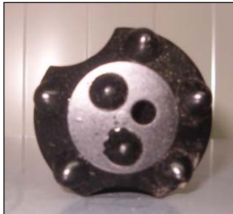
Ilustración 41: Boca fabricada por Boart Longyear en disposición 5+2 con botón parabólico (fotografía del autor)
