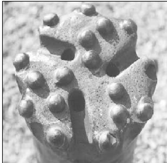
Ilustración 25: Boca de perforación con desgaste abrasivo (Fotografía cedida por Jack McGrath, Boart Longyear)
