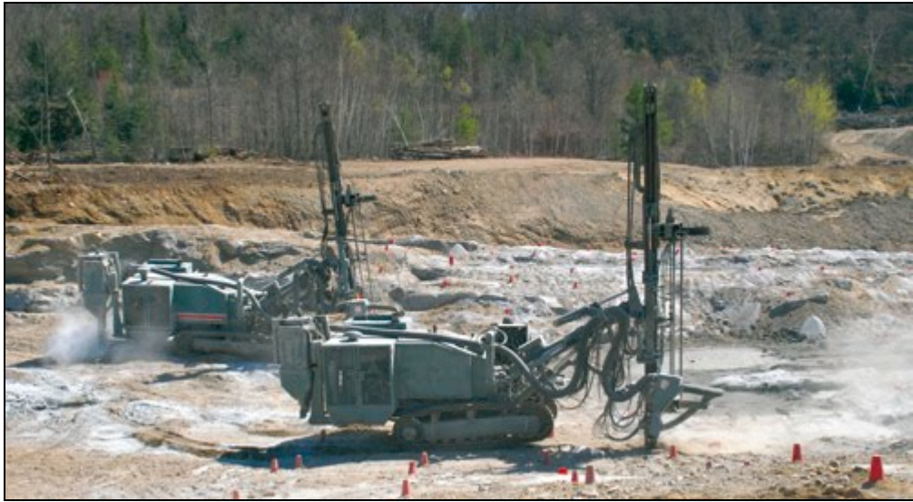
Ilustración 21: Carros de perforación de martillo en cabeza perforando barrenos para voladura ( www.riojaminer.com )
