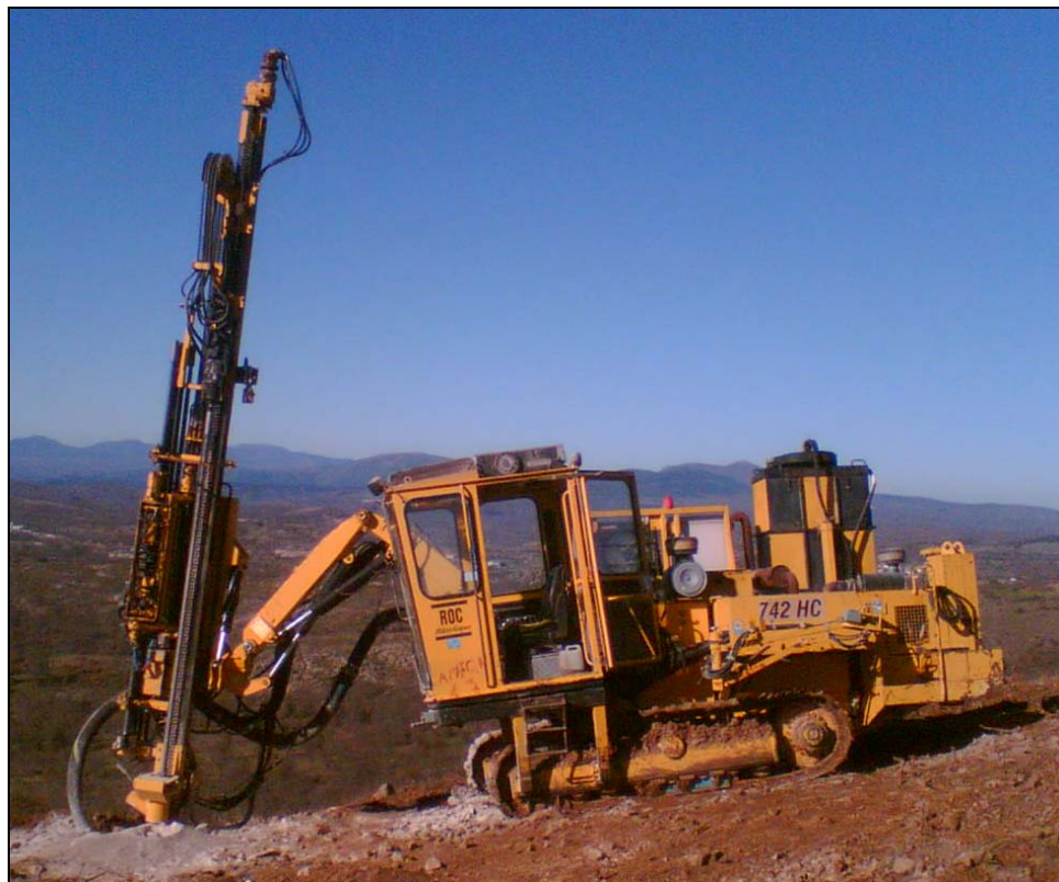
Ilustración 51: Carro de perforación Atlas Copco Roc 742 HC (fotografía del autor)
