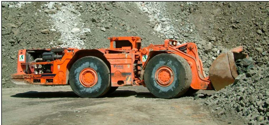
Ilustración 32: Pala Toro 1250 utilizada en el desescombro del túnel (Fotografía cortesía de INSERSA, 2006)
