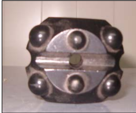
Ilustración 42: fabricada por Boart Longyear en disposición 4+2 con botón hemisférico (fotografía del autor)
