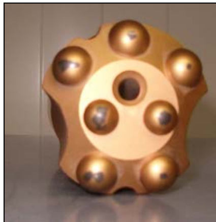
Ilustración 50: Boca fabricada por Mitsubishi en disposición 5+2 con botones hemisféricos (fotografía del autor)
