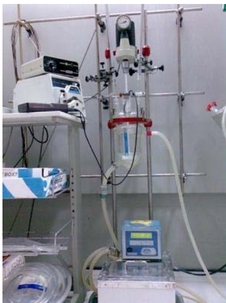
Fig. 28. Dispositivo experimental para la síntesis de hidrotalcitas por coprecipitación a sobresaturación baja
