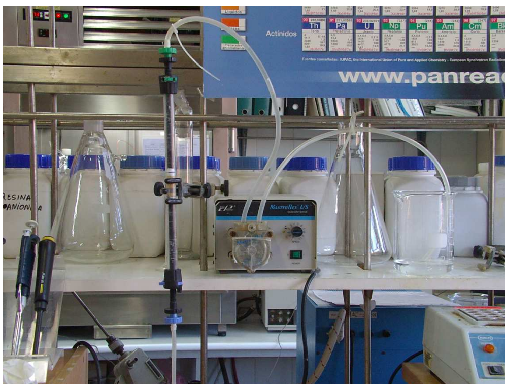
Fig. 8. Columna de vidrio de borosilicato cargada con resina catiónica Lewatit S-100 preparada para la fase de elución.
