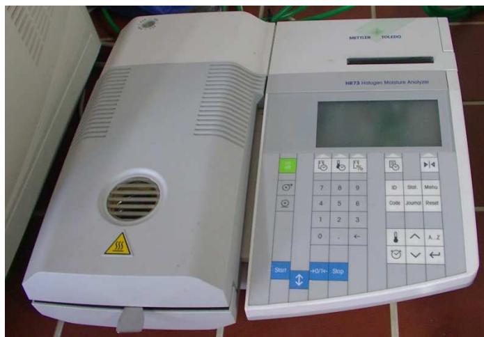
Fig. 10. Analizador halógeno de humedad Mettler Toledo HR73.
