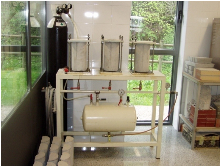
Figura 3.19 Ensayo de penetración de agua bajo presión.
