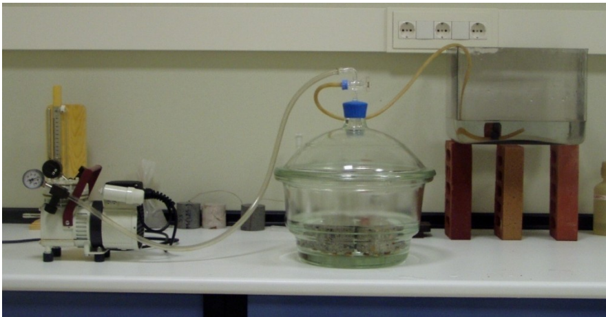
Figura 3.13 Ensayo de absorción en el hormigón endurecido.
