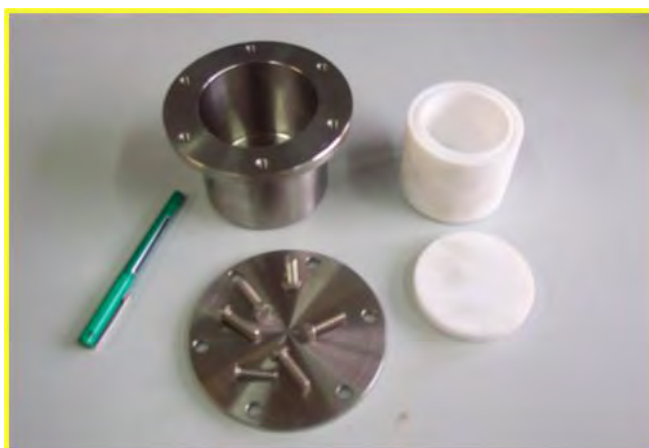
Figure 22. Image de l'autoclave en acier inoxydable et de son réacteur de 120 ml en téflon utilisés pour la synthèse hydrothermale dans notre laboratoire de l'université d'Oviedo.
