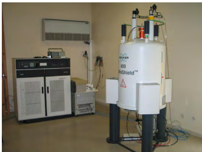
Figure 13. Spectromètre RMN à l'état solide. L'aimant supra-conducteur est indiqué sur la droite. La flèche représente la direction z du champ magnétique statique B_0 .
