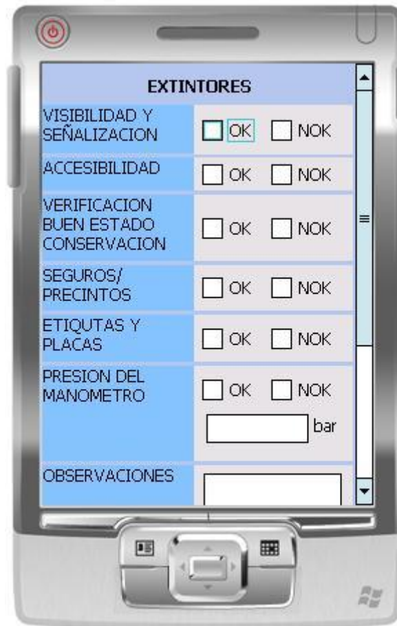
Ilustración 89.- Ejemplo de lista de comprobación de extintores sobre PDA
