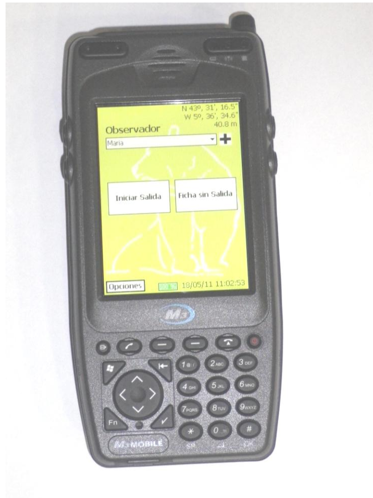
Ilustración 91.- PDA industrial con conectividad GPRS, cámara y wifi corriendo aplicación de OZE para la inspección en campo de la actividad del Oso pardo cantábrico.
