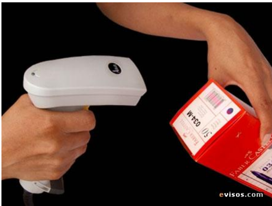
Ilustración 2.-Se necesita tener visión directa entre el lector y el código de barras.
