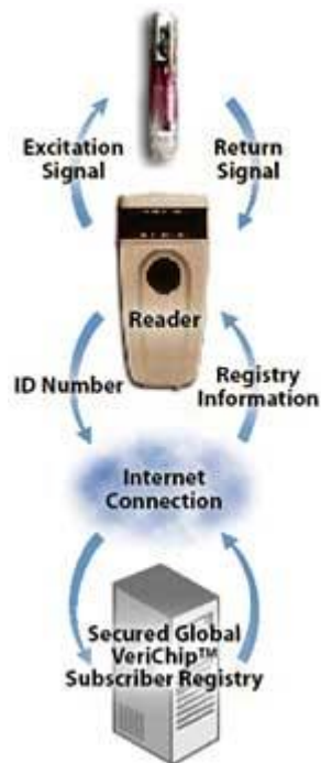
Ilustración 56.-Esquema de funcionamiento de un RFID implantable
