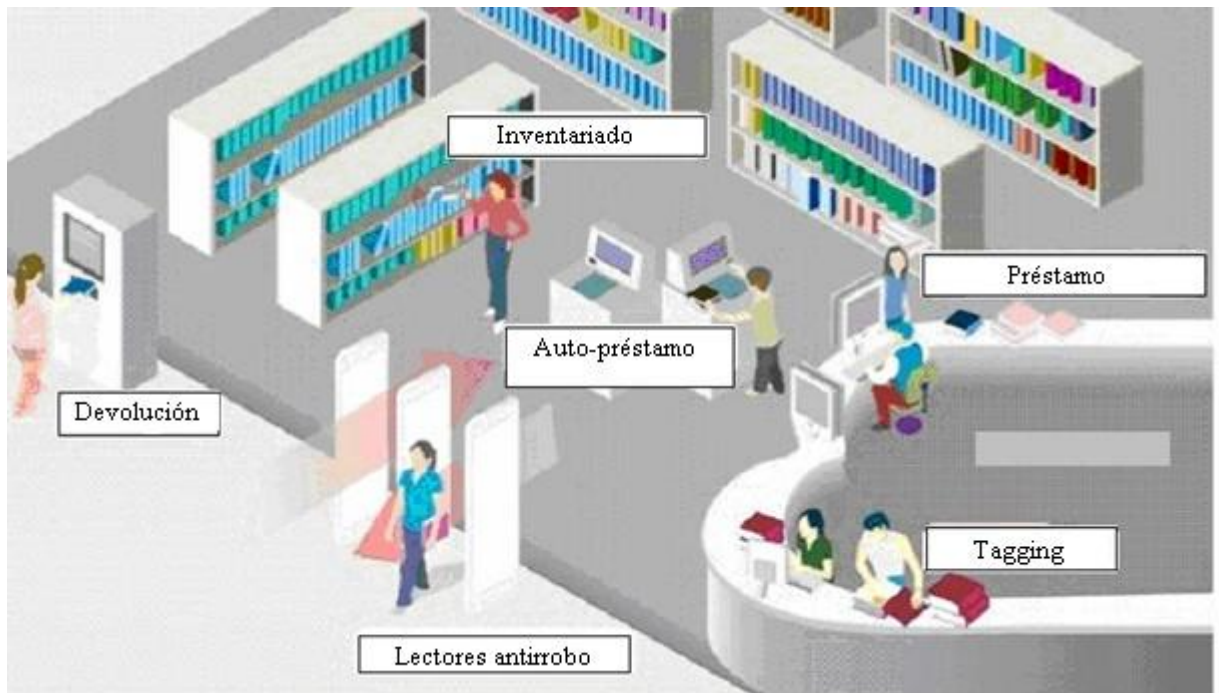
Figura 3.34. Esquema de funcionamiento de una biblioteca con el sistema RFID
