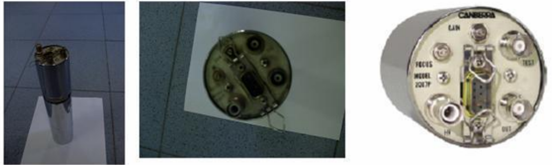
Figura 68. Detector y zócalo del preamplificador Modelo 2007P.
