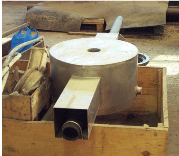
Figura 97. Estructura del prototipo manual con la guía del nuevo portamuestras (sección circular).
