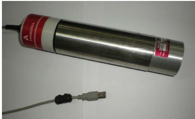
Figura 82. Detector de NaI acoplado al multicanal Unispec.
