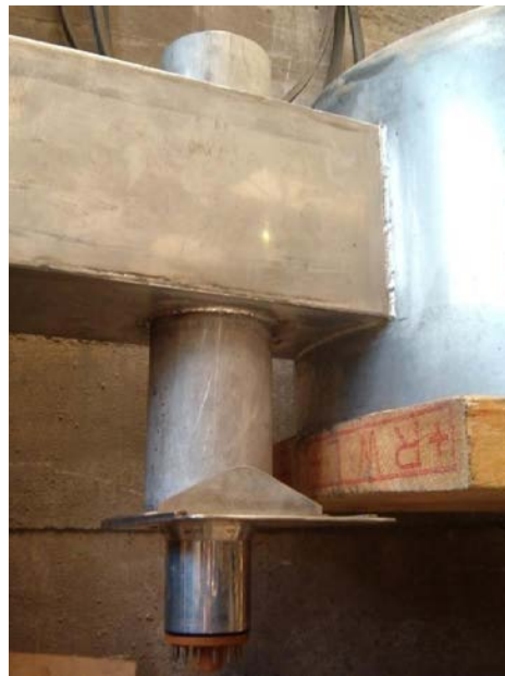
Figura 106. Guía del portamuestras del lado del detector. Detector en su soporte. La lámina deslizante hace de soporte del detector.
