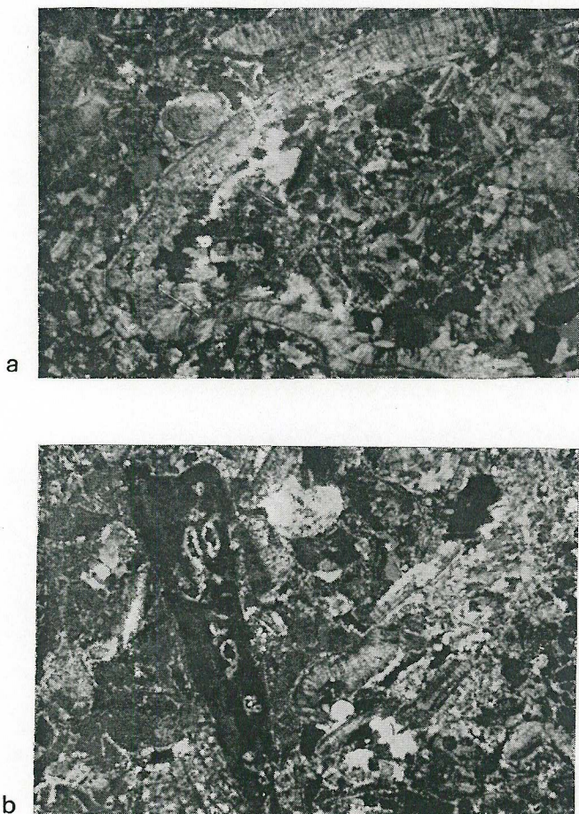
Figura 10.—Variedades de grano grueso de la caliza de Hontoria: a) procedente de una muestra tomada en cantera; b) procedente de una muestra de la Catedral de Burgos. (M.O.P. x10, NC).
