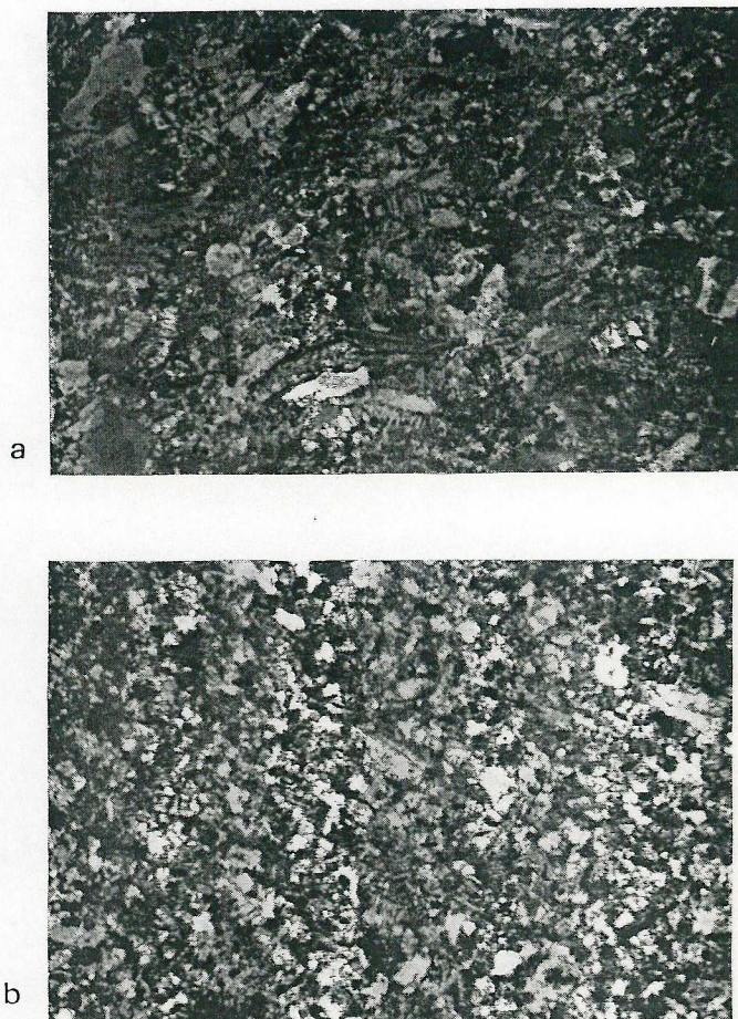
Figura 11.—Variedades de grano fino: a) procedente de una muestra de las canteras «militares», b) procedente de una muestra de la Catedral de Burgos. En ambas resalta su completa cementación y el elevado grado de recristalización. (M.O.P. x10, NC).
