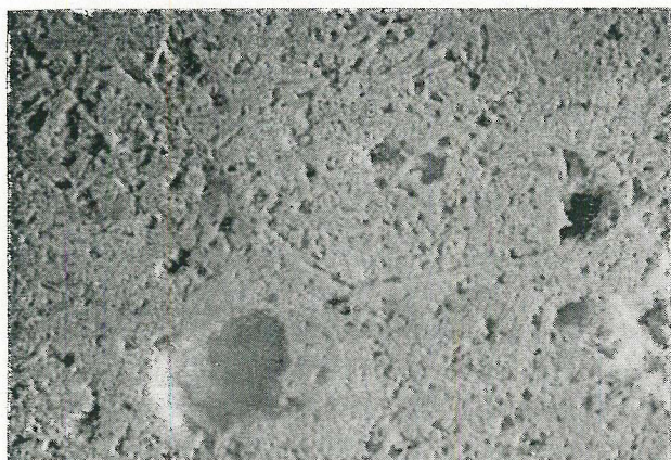
Figura 7.—Aspecto macroscópico de la variedad de cantera mostrando una superficie de corte de sierra. Pueden observarse las características de los granos (bioclastos) y de los poros. En la parte inferior aparece un poro de gran tamaño tapizado por calcita.
