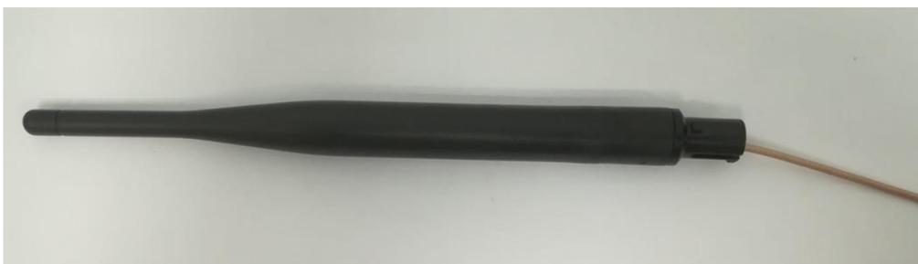
Figura 3.4.- Antena Xbee SX868.
