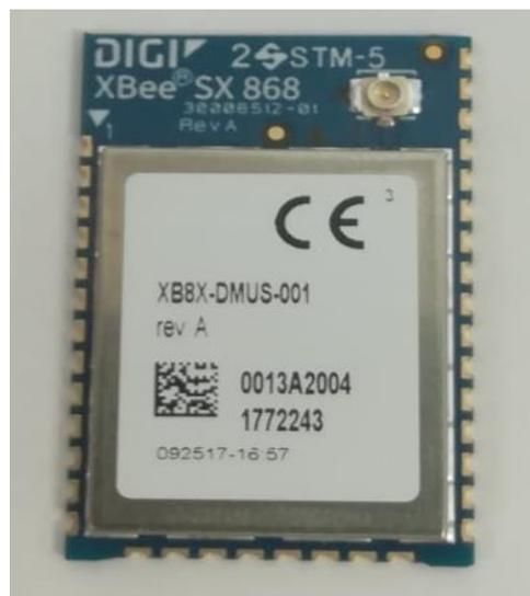
Figura 3.2.- XBee SX868.
