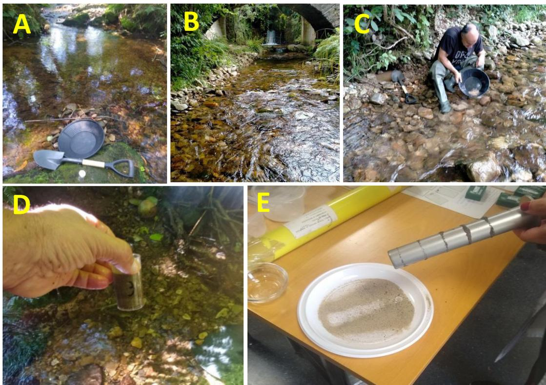
**Figura 37. A. Material empleado en el muestreo y la concentración. B. Punto de muestreo 13 (arroyo de Muñas). C. Ensayo a la batea. D. Cola de bateo, idealmente con la fracción densa de la muestra original. E. Aspecto de la cola de bateo, una vez seca, durante la separación magnética.**
