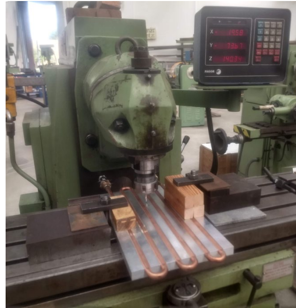
Figura 3.35 b) Enfriador fijado a la mesa de mecanizado.
