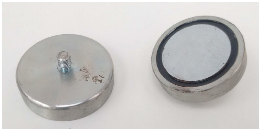
Figura 3.39 - Imanes para la fijación del prototipo al bloque motor.
