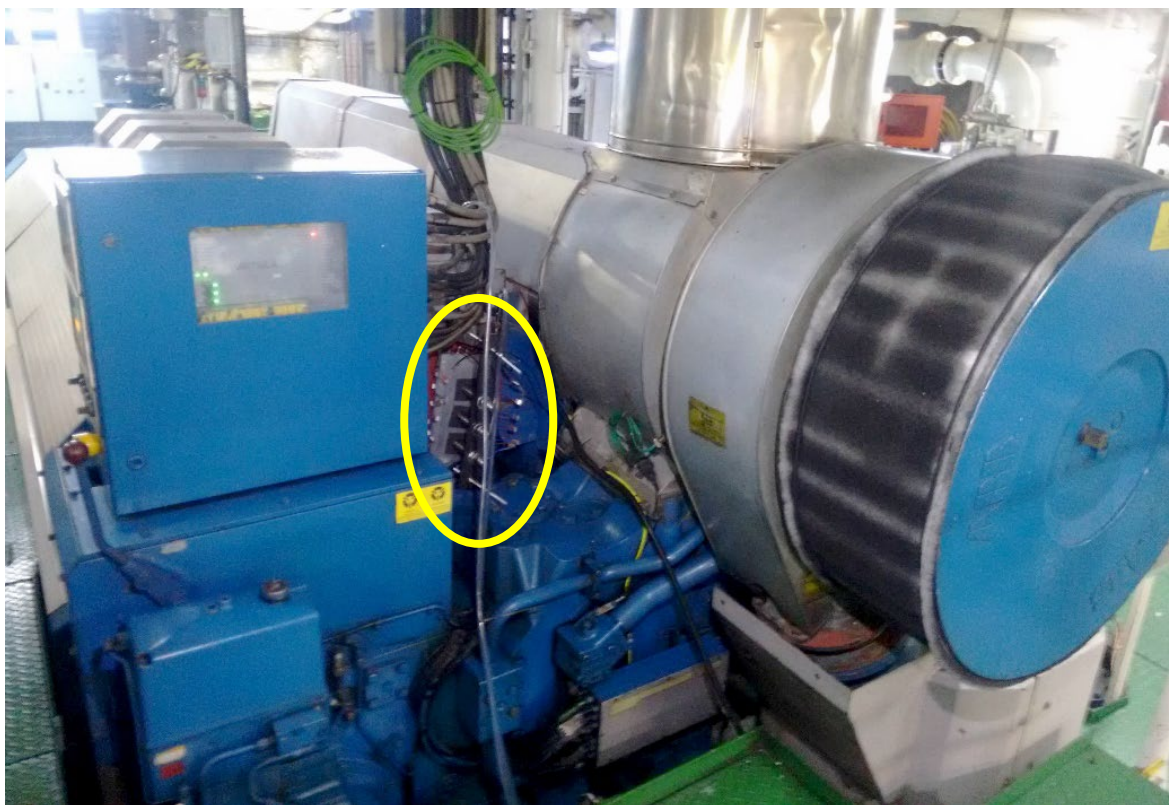
Figura 3.50 a) Captador termoeléctrico instalado en el motor.
