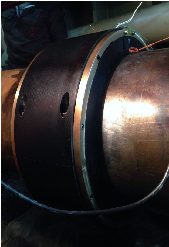
Figura 3.7 b) Torsiómetro instalado sobre el eje de propulsión.
