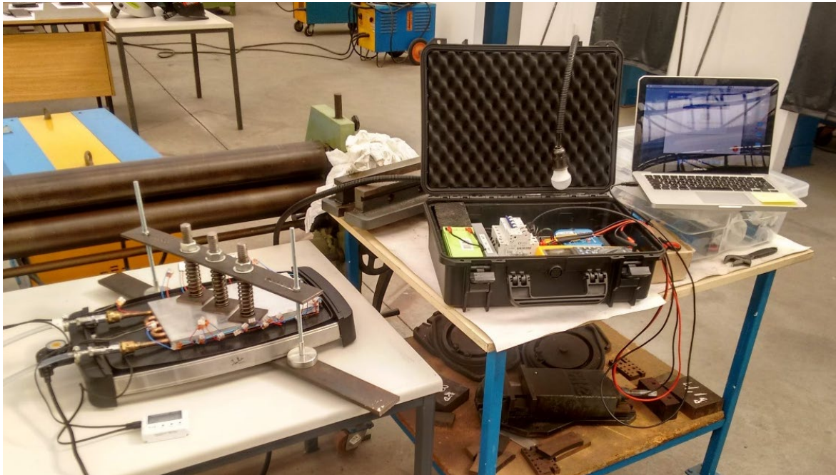
Figura 3.49 - Pruebas de taller y puesta en marcha del captador termoeléctrico.
