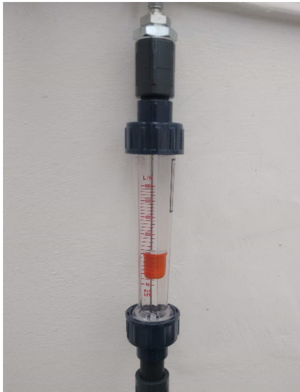
Figura 3.47 - Rotámetro utilizado para el ajuste del caudal de refrigeración del prototipo.
