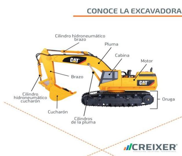
Figura 1.1 Excavadora [Imagen genérica de excavadora]
