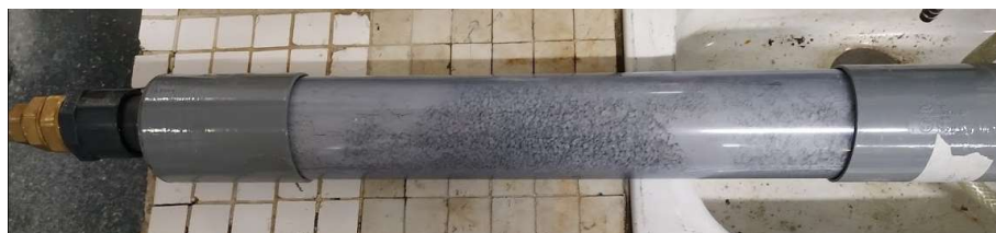
Figura 35.- Disposición del ensayo de lavado
