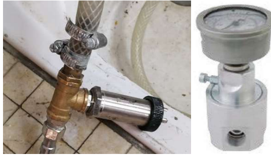
Figura 26.- Sensor de presión y sistema de protección
