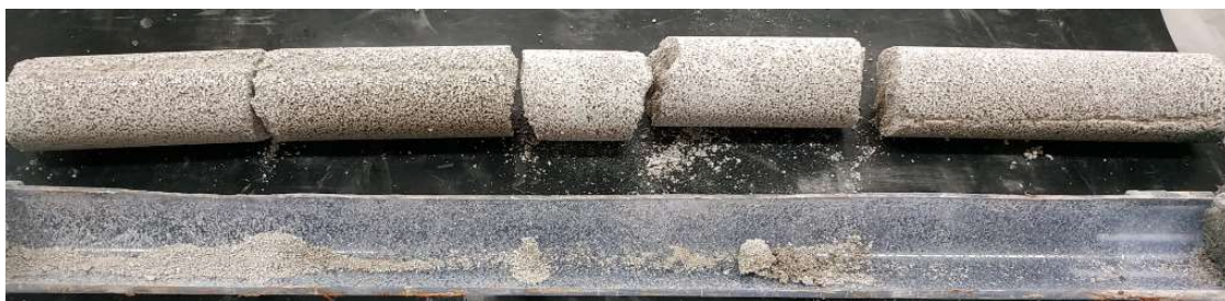
Figura 46.- Inyección de microcemento 2:1 en granulometría 0,5-2 mm
