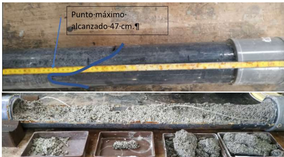
Figura 44.- Aspecto del material tras el ensayo, con solo la parte inicial impregnada
