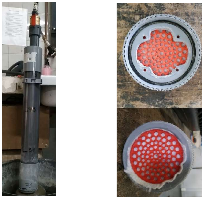
Figura 24.- Tubo de ensayos con el cabezal de inyección en la parte superior y detalle del filtro inferior
