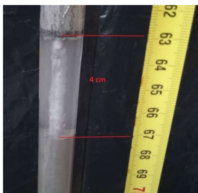
Figura 21.- Lámina superior de agua por segregación de la lechada
