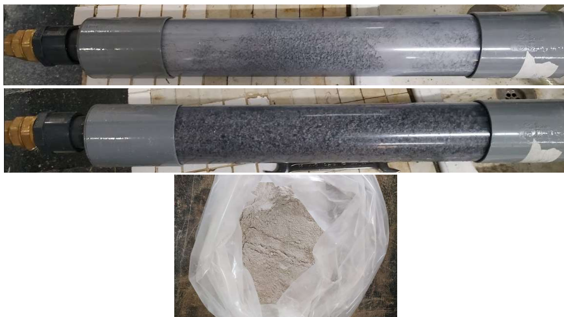
Figura 51.- Aspecto inicial de la muestra y tras el ensayo (dos lavados) y material extraído
