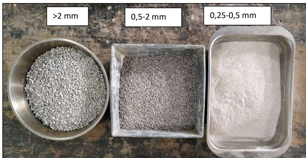
Figura 31.- Aspecto de las tres fracciones granulométricas diferenciadas
