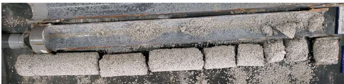
Figura 38.- Aspecto de la granulometría > 2 mm tras la inyección 2:1
