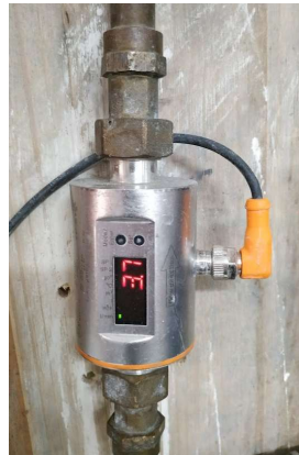
Figura 25.- Caudalímetro empleado durante un ensayo que registra 3,7 l/min
