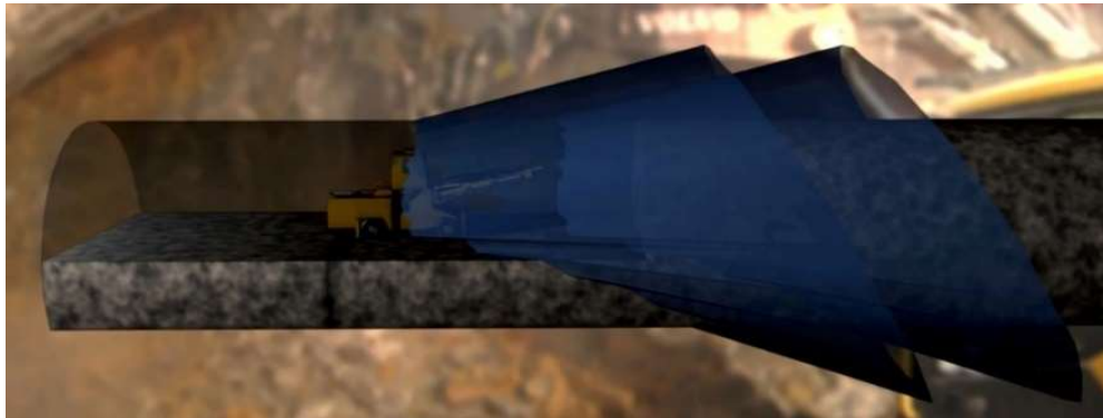
Figura 60.- Solape de etapas de Inyección en Avance
