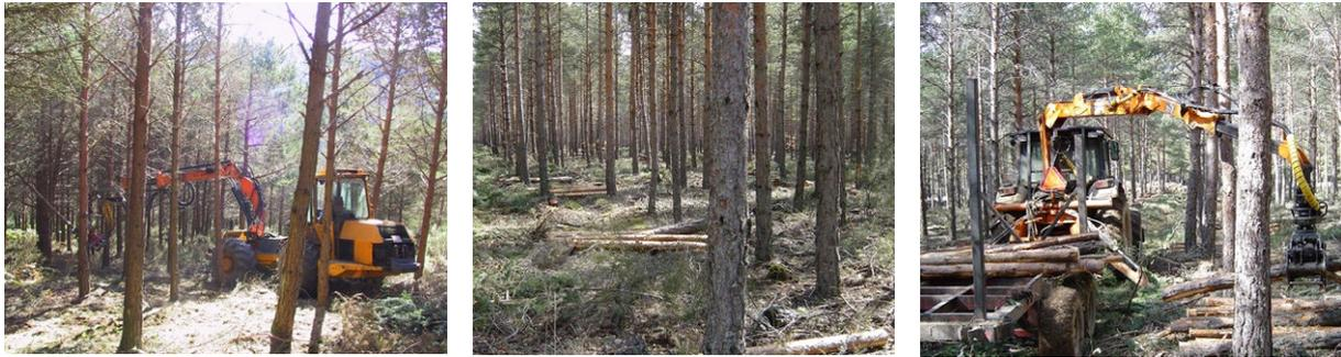
**Figura 11.33.** Detalle del apeo, procesado y apilado mecanizado con cosechadora forestal en la ejecución de una clara en una plantación de pino silvestre (izquierda). Detalles de las pilas de madera en el lateral y restos de corta sobre la calle (centro). Desembosque con tractor agrícola adaptado para el desembosque de madera corta en remolque (derecha) (Fotos: M. Barrio Anta y F. Veiga Aguiar).
