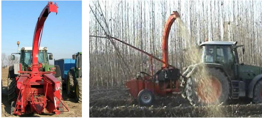
**Figura 11.55.** Cabezal de la firma italiana Spapperi para cosechar cultivos energéticos leñosos gestionados a turno corto (izquierda). Detalle de su utilización (derecha) (Fotos: Spapperi).
