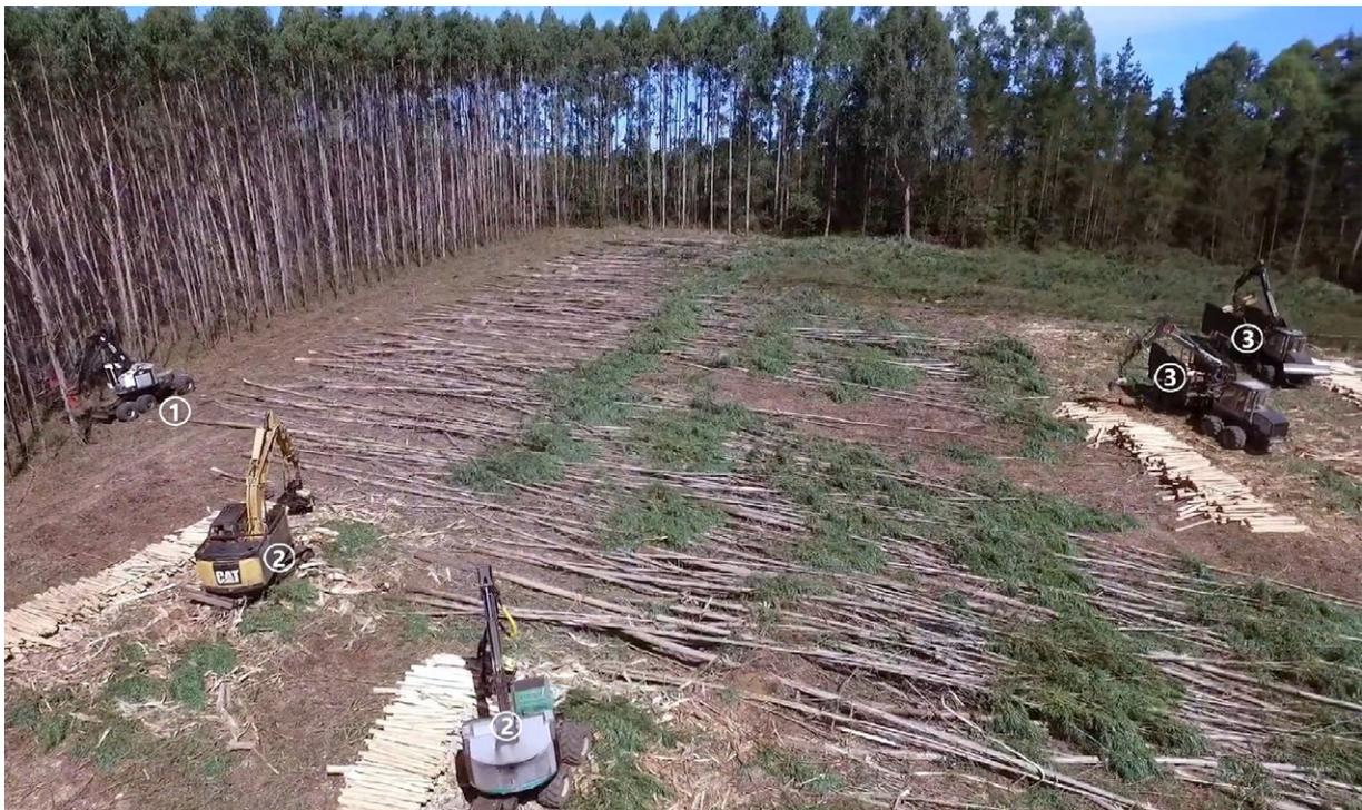
**Figura 11.25.** Sistema completamente mecanizado (MC-3-AT) en un aprovechamiento de eucalipto en el norte de España. La alta productividad de la taladora apiladora de disco (1), requiere de dos cosechadoras (2) para realizar el procesado (en este caso incluye descortezado) y dos autocargadores para el desembosque (3) (Foto: Maderas Paco Cacharolo).
