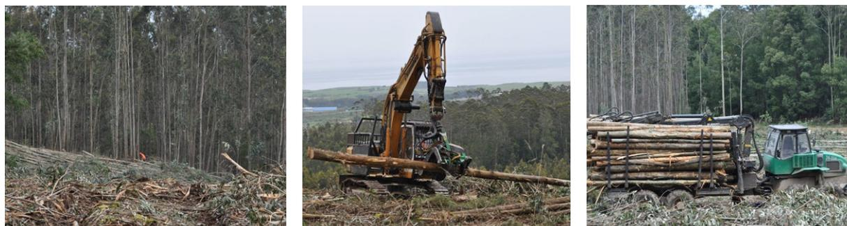
**Figura 11.29.** Aplicación del sistema parcialmente mecanizado con el método de aprovechamiento de madera larga (ML-1-AT) en eucalipto. Apeo manual con motoserrista (izquierda), procesado con cosechadora sobre retroexcavadora adaptada (centro) y desembosque con autocargador (derecha) (Fotos: M. Barrio Anta).
