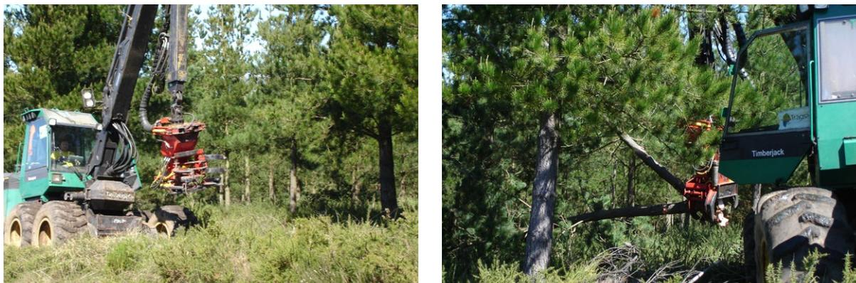
**Figura 11.38.** Tractor forestal Timberjack de seis ruedas motrices con cabezal talador-apilador de cuchillas (izquierda) y ejecución de una clara en pino radiata en Asturias empleando el método de árbol completo o partes de árbol con el equipo anterior (derecha) (Fotos: M. Barrio Anta).
