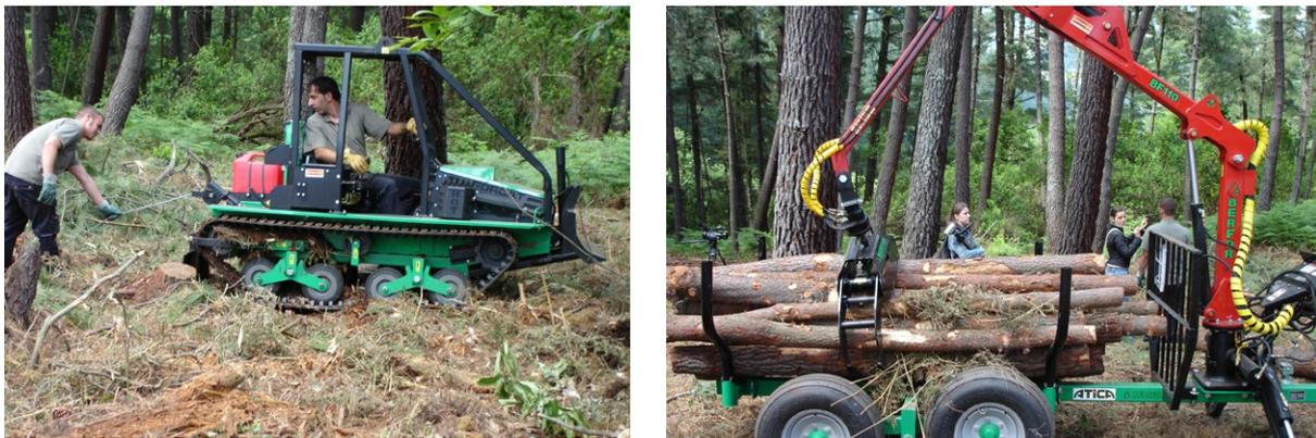
**Figura 11.46.** Ejemplos de pequeñas máquinas para realizar el desembosque de madera (Fotos: M. Barrio Anta).
