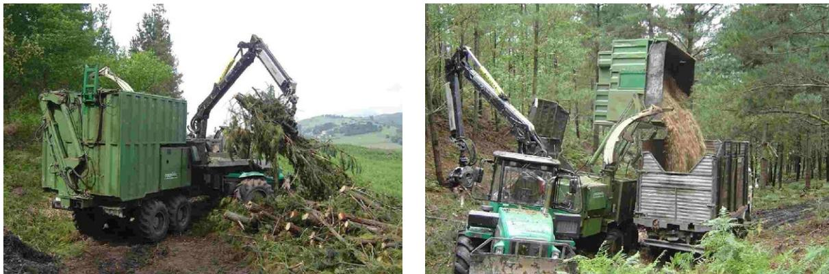
**Figura 11.52.** Unidad de astillado Pezzolato sobre autocargador Dingo de 6 ruedas motrices astillando partes de árbol, en este caso a borde de pista, no en zona de corta (izquierda) y detalle del basculado lateral de la caja contenedora para el vertido de la astilla sobre caja de camión (derecha) (Fotos: Consejería de Medio Ambiente y Desarrollo Rural del Principado de Asturias).
