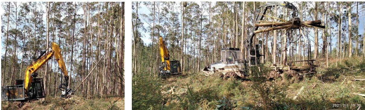
**Figura 11.31.** Detalle del apeo y procesado mecanizado con cosechadora forestal en un aprovechamiento de eucalipto empleando el método de aprovechamiento de madera larga. Detalles de la carga de las pilas de madera formadas en autocargador (derecha). El sistema de aprovechamiento usado es el ML-2-AT (Fotos: E. García Coya).
