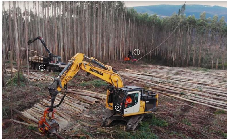
**Figura 11.36.** Aprovechamiento completamente mecanizado utilizando el método de madera larga y uso tres máquinas: taladora-apiladora para el apeo y apilado (1), cosechadora forestal para el procesado (2) (en este caso cabezal procesador instalado en punta de grúa de retroexcavadora adaptada), y autocargador para el desembosque (3). Sistema de aprovechamiento ML-3-AT (Foto: Forestal Ría de Abres).
