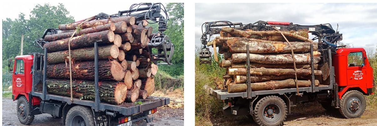
**Figura 11.24.** Empleo de camión todoterreno de pequeño tamaño (carroceta) de la marca IPV en el desembosque de madera de pino (izquierda) y de frondosa (derecha) (Fotos: R. González Fernández).
