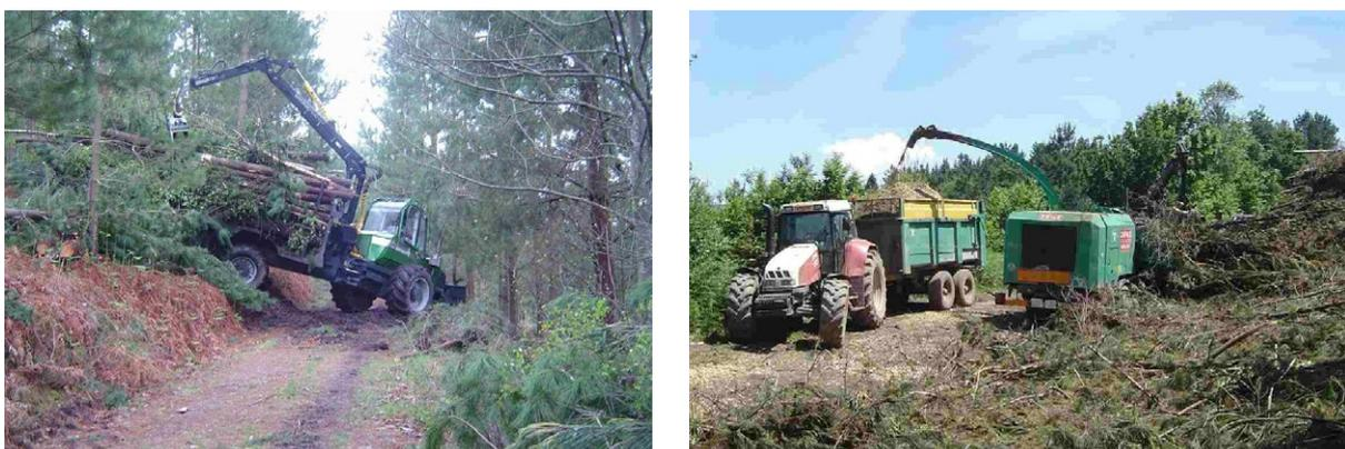
**Figura 11.40.** Desembosque de árboles (enteros o trozos) con autocargador (izquierda). Astillado en cargadero con una astilladora móvil (Fotos: Consejería de Medio Ambiente y Desarrollo Rural del Principado de Asturias y Tragsa).
