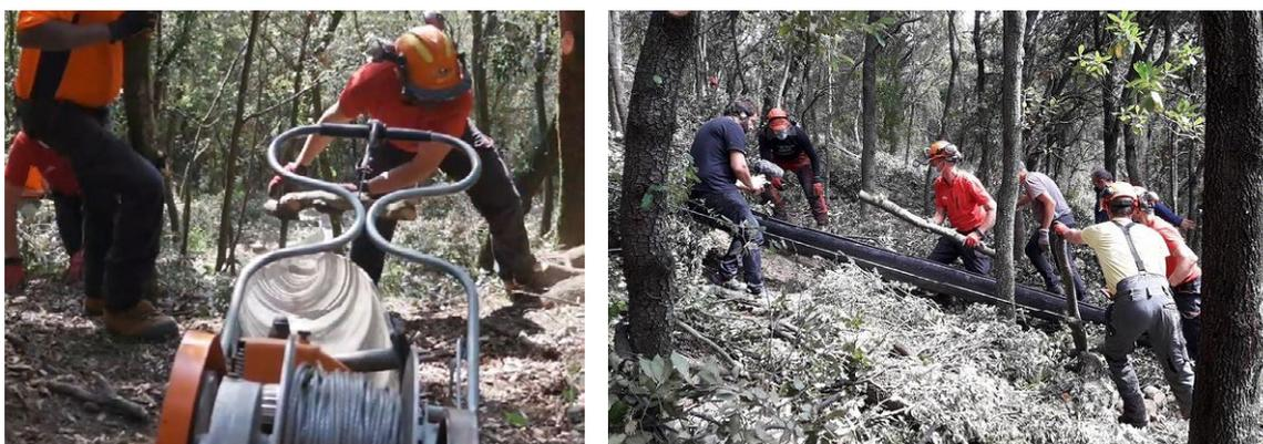
**Figura 11.50.** Cabrestante sobre sobre trineo para desplazar las canaletas (izquierda) y detalles del desembosque (derecha) en una experiencia de uso de canaletas para desemboscar leñas en un aprovechamiento en el Parque Natural de la Garrotxa, Cataluña (Fotos: Wiebrig Broersma/ONF).
