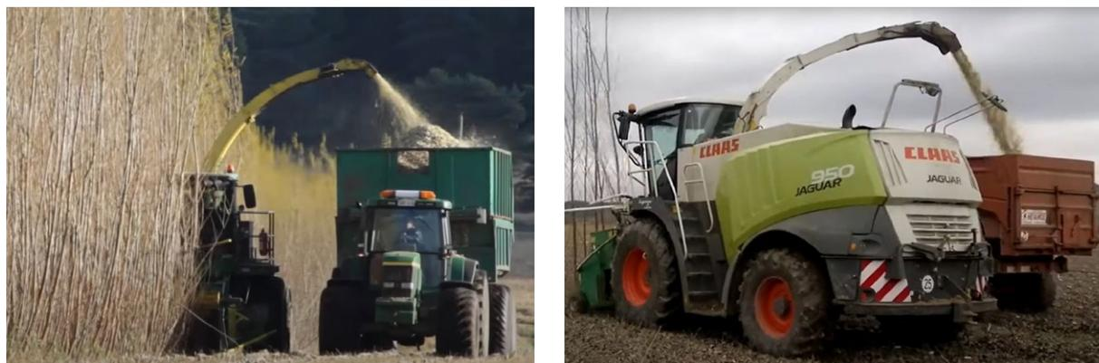
**Figura 11.54.** Cosechado con cosechadora agrícola adaptada y desembosque con tractor agrícola con remolque de caja cerrada (Sistema MA-2-TA) (Fotos: Proyecto Rockwood, izquierda y Biopoplar, derecha).
