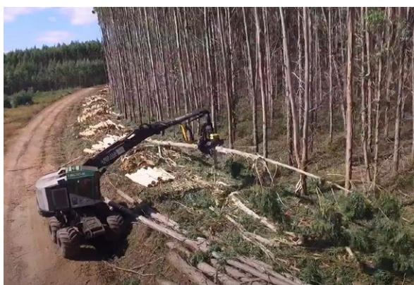
**Figura 11.35.** Detalle del apeo con cabezal talador-apilador de disco, seguido del procesado con cabezal cosechador. Ambos sobre máquinas base de ruedas Timber Pro (Fotos: Maderas Paco Cacharolo).
