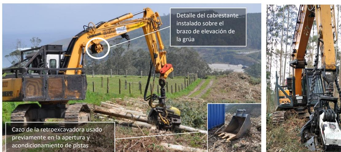
**Figura 11.27.** Máquina retroexcavadora de cadenas adaptada para el trabajo forestal y dotada de cabezal cosechador en punta de grúa y cabrestante en el brazo de elevación (Fotos: M. Barrio Anta).
