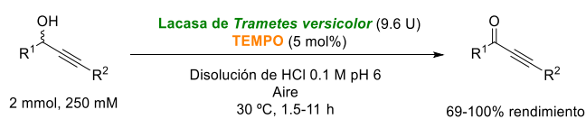
Esquema 24. Oxidación de alcoholes propargílicos empleando la lacasa de Trametes versicolor y TEMPO.
