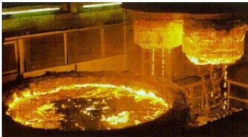
Figura 2.1.-Cuchara de acero líquido y trompas de la instalación RH
