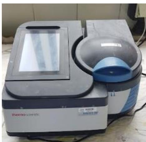
Figura 19. Espectrofotómetro Thermo Scientific™ UV-Vis GENESYS™ 150.
