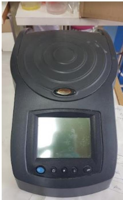
*Figura 14. Espectrofotómetro Analytik Jena SPEKOL 1300/1500*
