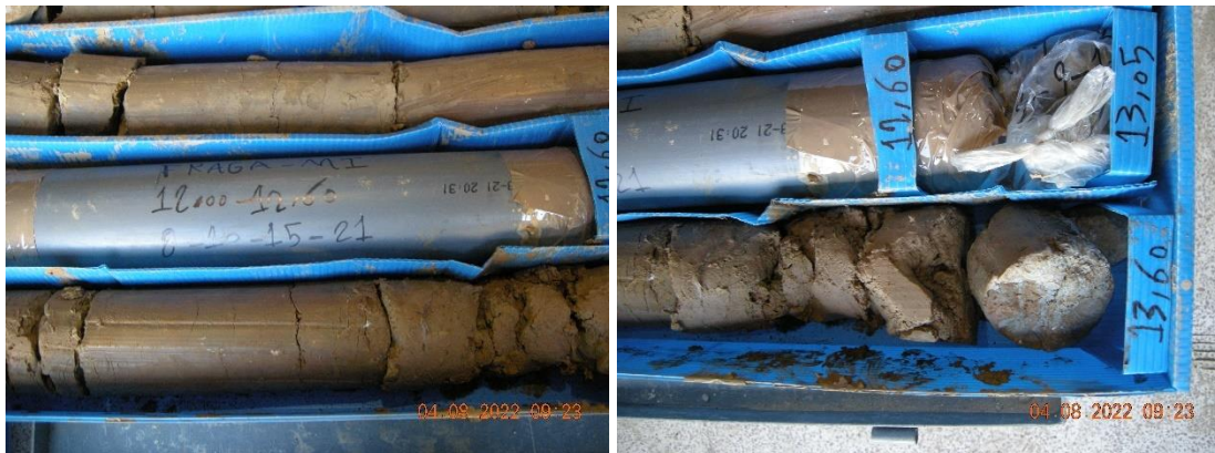
Figura 2.4. Ejemplo de muestras inalteradas tomadas en el sondeo S-1.
