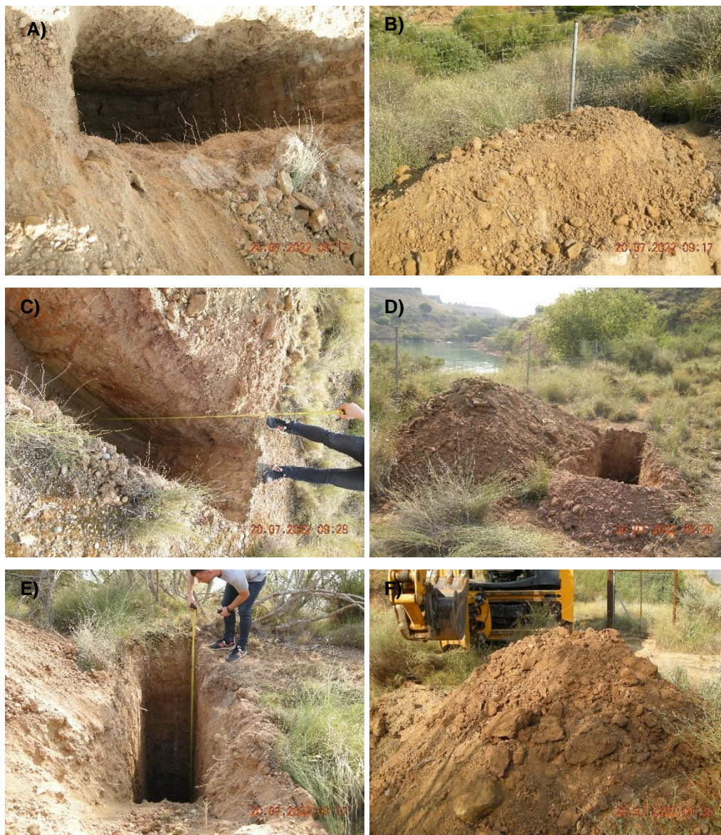
Figura 3.4. Fotografías de las calicatas. A) Fondo de la calicata C-1. B) Material extraído de la calicata C-1. C) Fondo de la calicata C-2. D) Material extraído de la calicata C-2. E) Fondo de la calicata C-3. F) Material extraído de la calicata C-3.
