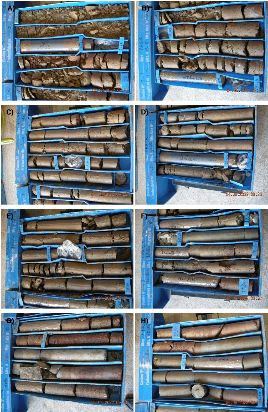
Figura 3.2. Fototestificación del sondeo S-1. A) Caja n.º 1: profundidad 0,00 m a 3,40 m. B) Caja n.º 2: profundidad de 3,40 m a 7,05 m. C) Caja n.º 3: profundidad 7,05 m a 16,80 m. D) Caja n.º 4: profundidad 10,20 m a 13,60 m. E) Caja n.º 5: profundidad 13,60 m a 16,80 m. F) Caja n.º 6: profundidad 16,80 m a 19,80 m. G) Caja n.º 7: profundidad 19,80 a 22,80 m. H) Caja n.º 8: profundidad 22,80 m a 25,60 m.
