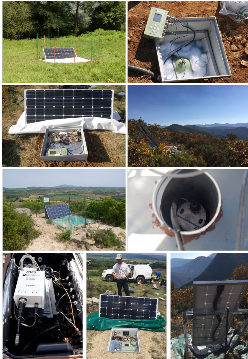
Figura 2.3: Imágenes de algunas de las estaciones temporales utilizadas en este trabajo, incluyendo las dos combinaciones de sensor y estación sísmica. La fotografía A muestra una estación de registro Taurus con un sensor Trillium 120 rodeado de aislante térmico dentro de la arqueta de PVC. La fotografía B muestra la instalación del sensor Trillium Compact Posthole, en el interior de un tubo de PVC enterrado. La fotografía C muestra una de las estaciones Centaur.
