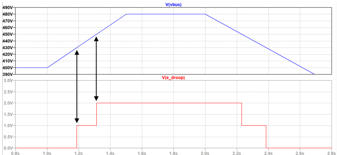
Fig 58. Simulación control droop 3. Estado 3 de sobrecarga.
