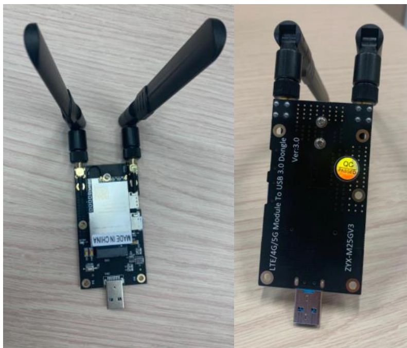
Figura 3. 6.- Módulo 5G montado y con la SIM insertada..
