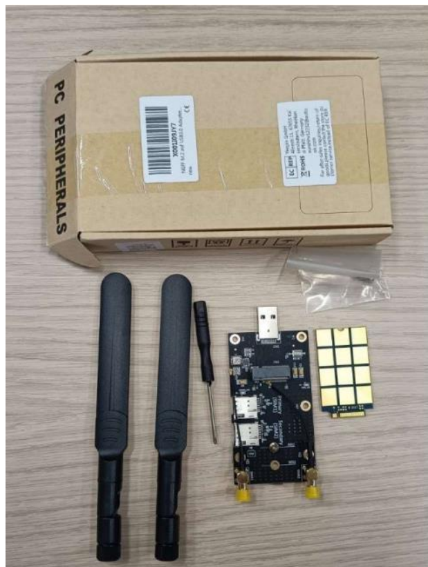
Figura 3. 4.- Kit de Queltec para el montaje del adaptador del módulo 5G a USB 3.0.
