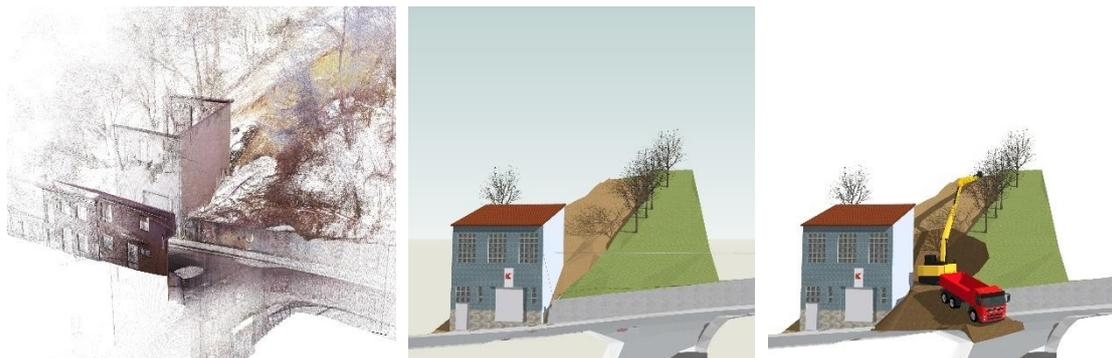
Figura 28. De la nube de puntos, al modelo inicial y al modelo final [Aplicaciones Geomáticas SL]
