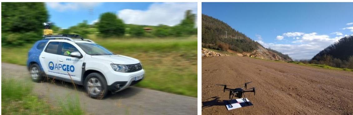
Figura 16 . Izquierda: Mobile mapping IP-S3. Derecha: dron [Excade SL]
