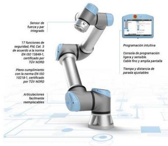
Figura 2: Elementos y Sistemas del Robot
