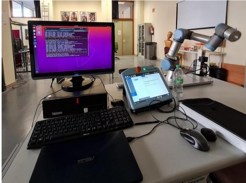
*Figura 33: Control del robot UR3e mediante Python*
