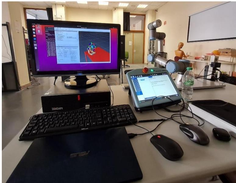
Figura 32: Control del robot UR3e mediante RVIZ
