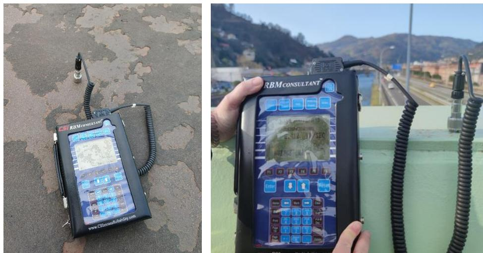
Ilustración 6. Toma de medidas en el plano vertical. A la izquierda, acelerómetro situado en el centro del tablero. A la derecha, en el ala.
