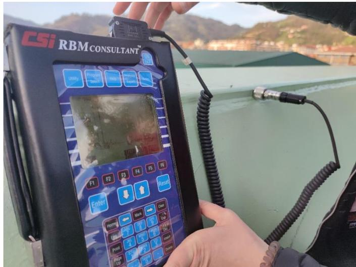
*Ilustración 4. Toma de medidas en el plano horizontal. El acelerómetro se sitúa en las alas.*
