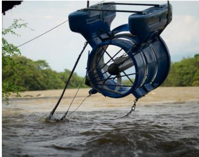
ILUSTRACIÓN 24. TURBINA HIDROCINÉTICA DE FLUJO AXIAL (LINQUIP,
