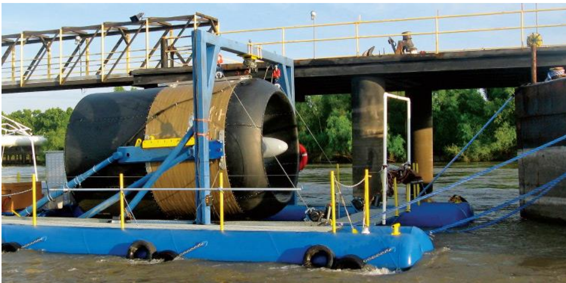
ILUSTRACIÓN 25. TURBINA HIDROCINÉTICA (FREE FLOW POWER CORPORATION, S.F.)
