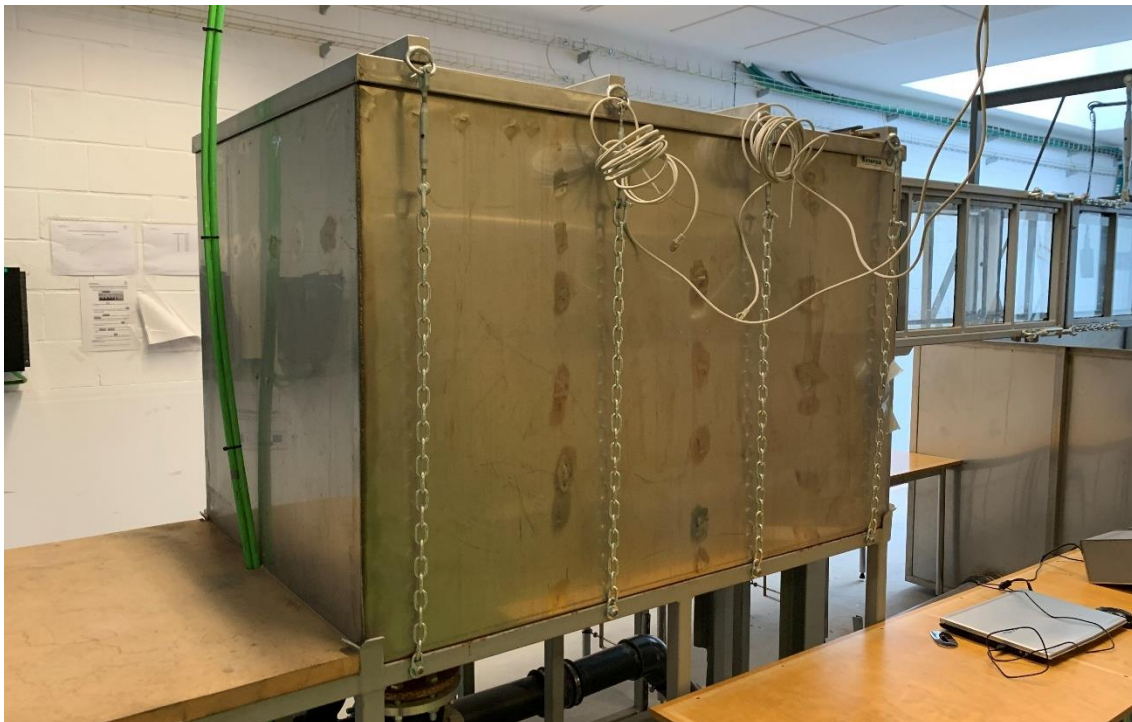
ILUSTRACIÓN 44. TANQUE DE TRANQUILIZACIÓN
