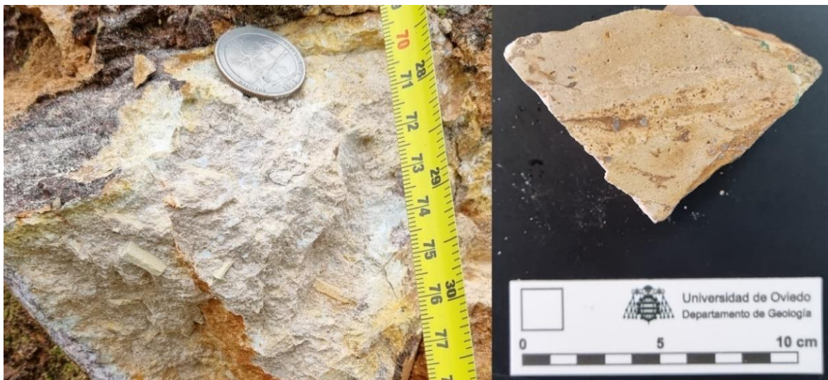
Figura 30: A la izquierda, fotografía de la muestra MQ-RM-7 tomada en campo, a simple vista se pueden observar los vestigios de los fenocristales reemplazados por minerales arcillosos. A la derecha fragmento utilizado para la elaboración de la lámina delgada.
