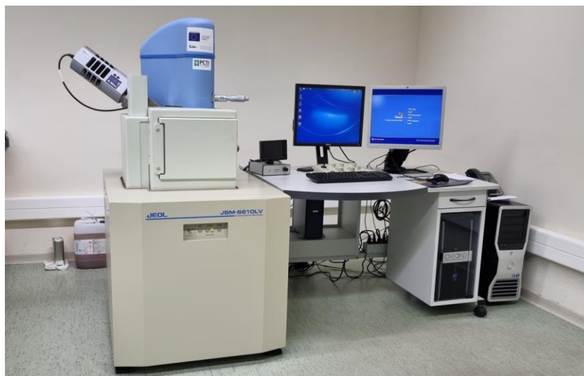
Figura 19: Microscopio electrónico de barrido (MEB), utilizado para este trabajo, ubicado en los servicios Científico-técnicos de la Universidad de Oviedo.
