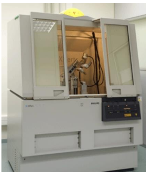
Figura 18: Equipo de Difracción de Rayos X, marca "PHILIPS X' PERT PRO", ubicado en los servicios Científico-técnicos de la Universidad de Oviedo.
