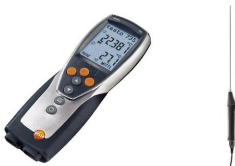
Figura 2. Termómetro de resistencia de platino (Medidor y sonda)<sup>8</sup>.
