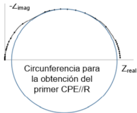
Figura 5.13. Trazado de la mayor circunferencia posible para determinar el primer CPE.[19]
