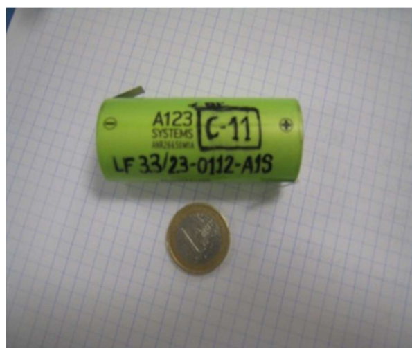
Figura 2.1.- Batería utilizada durante el proceso experimental y utilizada como modelo para la realización de la simulación COMSOL Multiphysics® (Modificado Tarascon & Armand, 2010).
