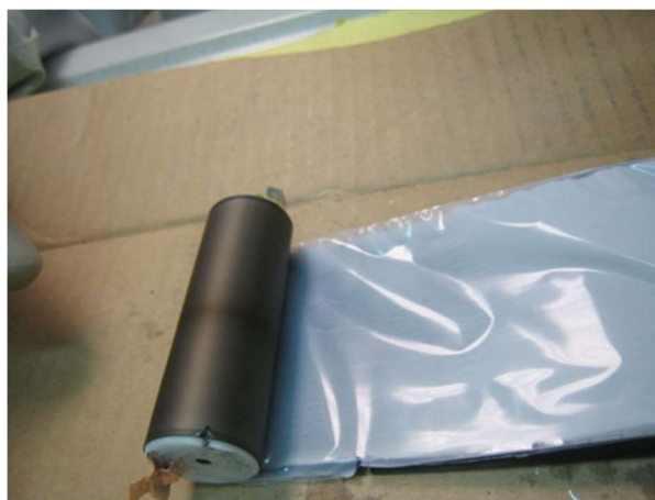
Figura 4.1.- Apertura de la batería ANR26650M1 por varios miembros del grupo de investigación del laboratorio de baterías de la Universidad de Oviedo.
