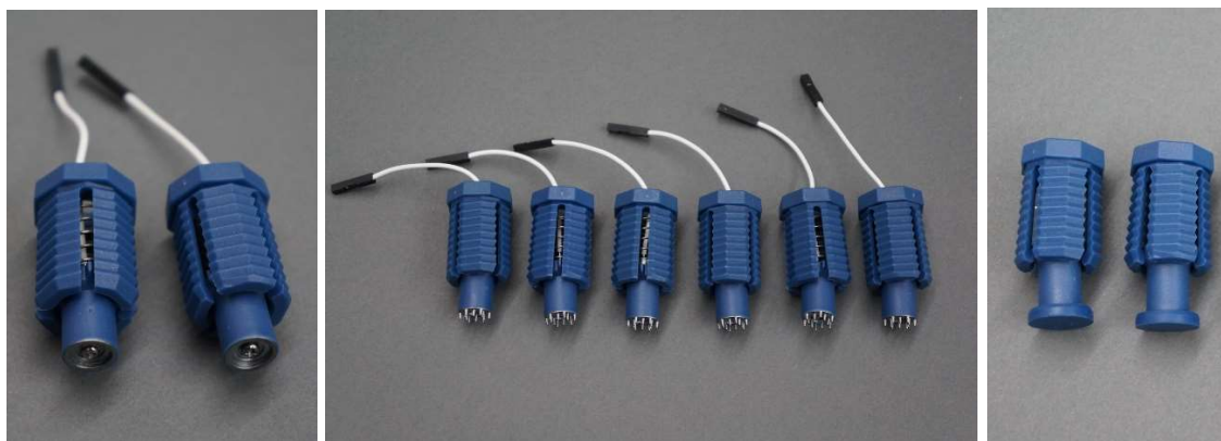
Fig 4.2.- Electrodo planos (izquierda), puntiagudos (centro), y elementos de apoyo (derecha).
