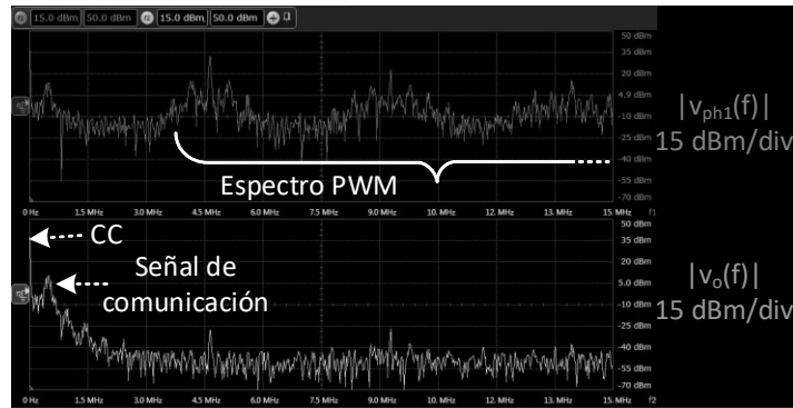
Figura 4.17: Representación en el dominio de la frecuencia del proceso de filtrado en el convertidor, donde se visualiza la magnitud del espectro a la entrada del filtro |v_{ph1}(f)|^2 y a la salida |v_o(f)|^2 .
