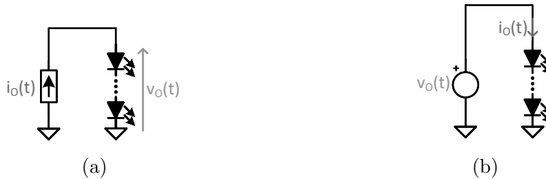
Figura 1.11: Modelos simplificados del driver VLC: en (a) se modela como una fuente de corriente, mientras que en (b) se modela como una fuente de tensión.
