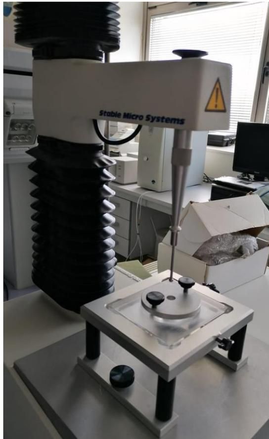
Figura 16: Texturometro con plataforma para colocar los fragmentos de film y la sonda P/5S utilizada para estudiar las propiedades mecánicas de los films.
