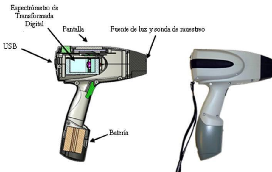
Figura 9. Esquema del equipo microPHAZIR mod 1640 ( Thermo Fisher Scientific Inc. , Wilmington, MA, USA).
