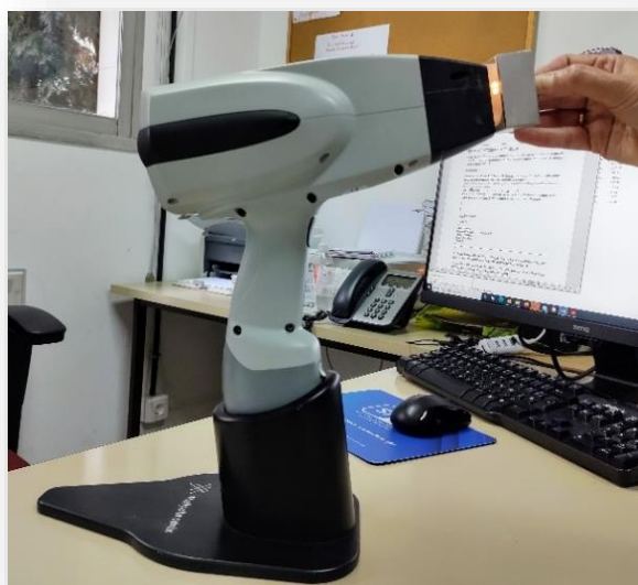
Figura 11. Toma del espectro NIRS con el equipo Phazir, empleando la cubeta.
