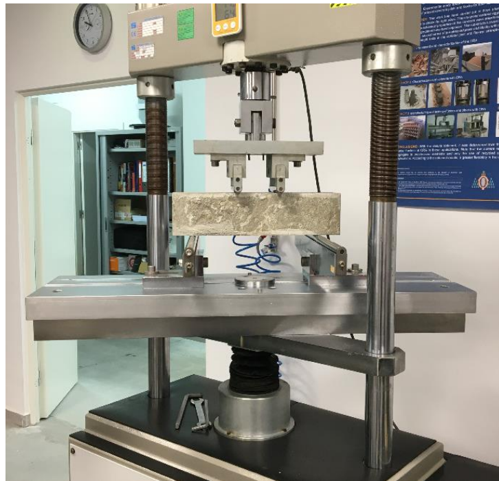
Figura 17. Ensayo flexotracción. Acción carga.
