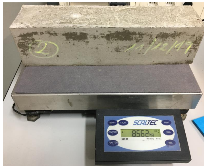
Figura 30. Peso de la probeta usada en el TEST 2
