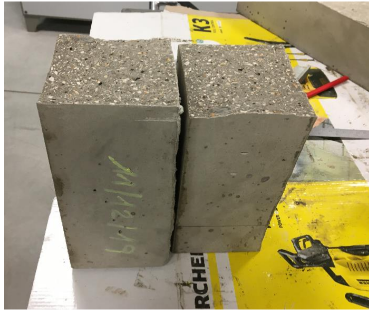
Figura 19. Ensayo flexotracción. Inspección visual rotura.
