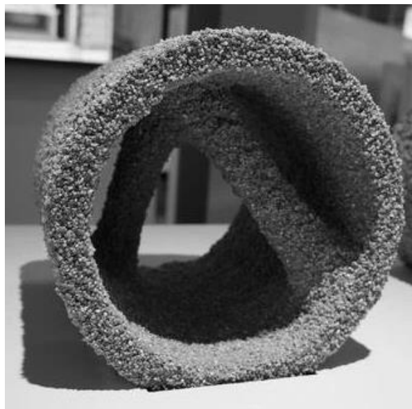
Figura 6. Método de intrusión selectiva de pasta de cemento [15].
