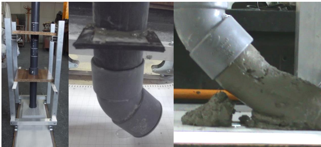
Figura 11. Carro de impresión, boquilla curva y deposición de un cordón.
