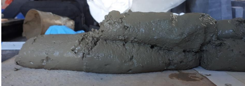
Figura 14. Aspecto de los cordones depositados de MI3D-4.
