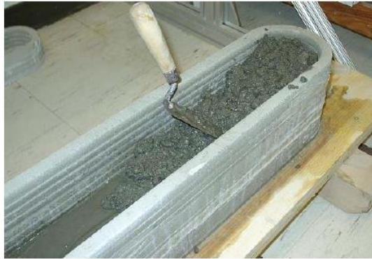
Figura 2. Encofrado con hormigón convencional [10].
