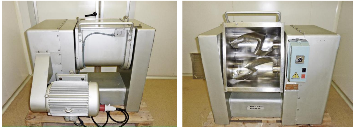
Figura 9. Amasadora de tipo doble sigma.
