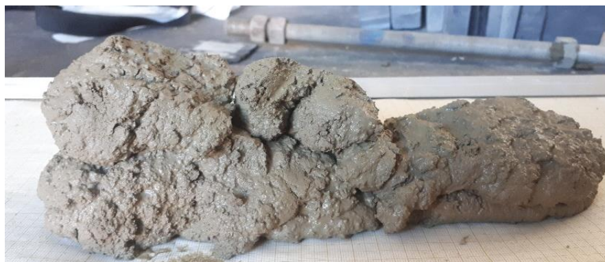
Figura 13. Aspecto de los cordones depositados de MI3D-3 (Derecha, dos cordones; Izquierda, tres cordones).
