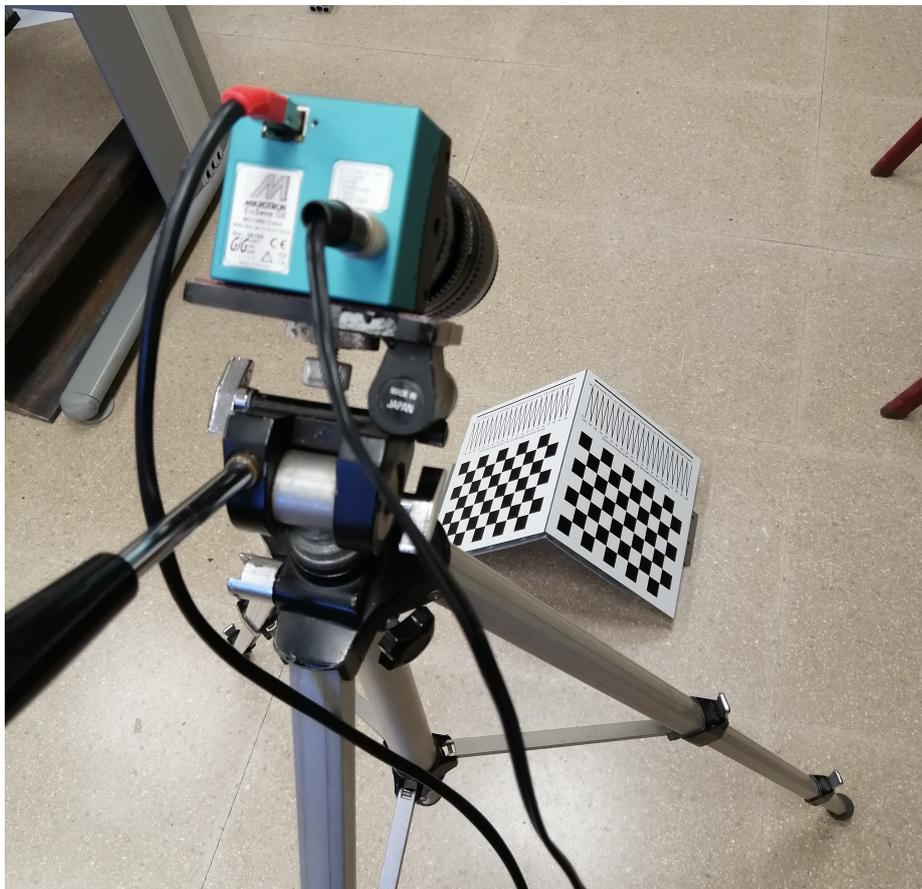
Figura 5.9: Colocación para la obtención de imágenes matriciales
