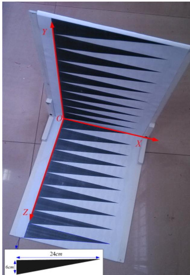
Figura 3.5: Patrón de calibración utilizado por [22] ©2014 Published by Elsevier Ltd.
