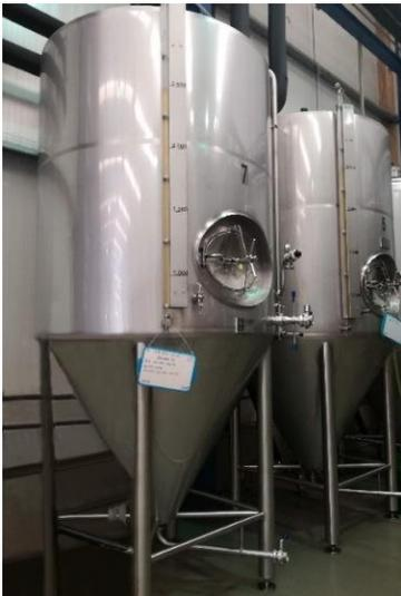
Figura 1.a. Tanque cilíndrico de fermentación de cerveza de la empresa Caleyá.
