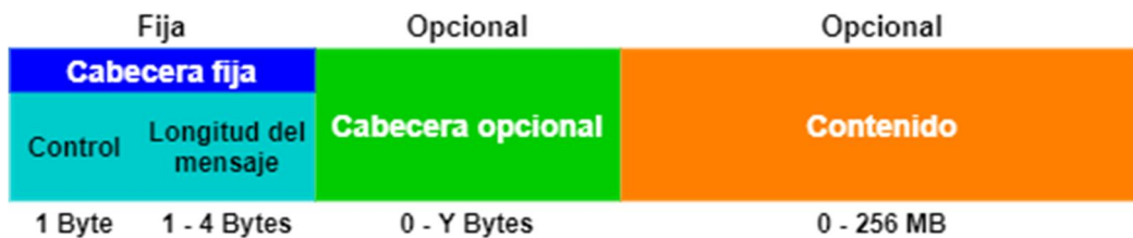
Figura 6.6.- Estructura de los mensajes del protocolo MQTT.
