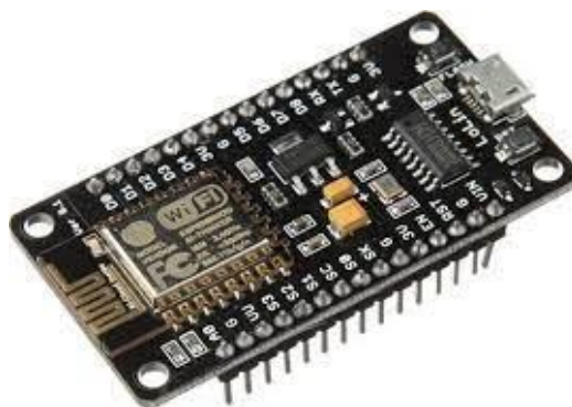
Figura 5.3.- Placa de desarrollo NodeMCU con microcontrolador ESP8266.
