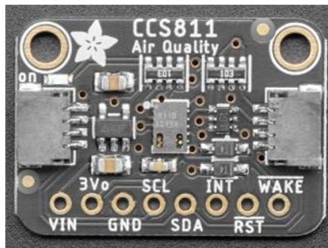
Figura 5.9.- Sensor CCS811 para mediciones de CO 2 y VOC (imagen obtenida del “datasheet” del sensor [49]).
