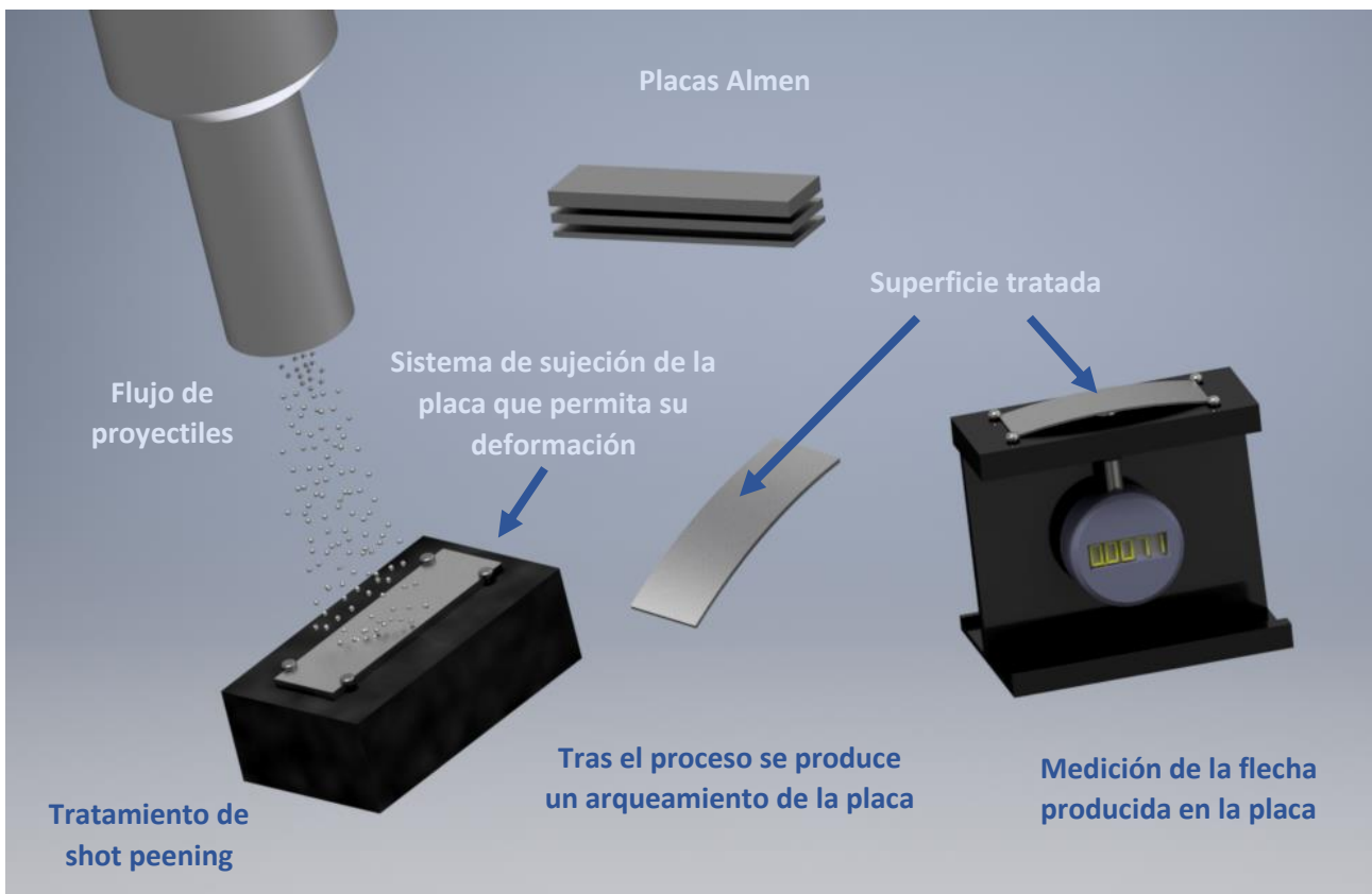
Figura 8: Esquema del proceso para determinar de la intensidad Almen
