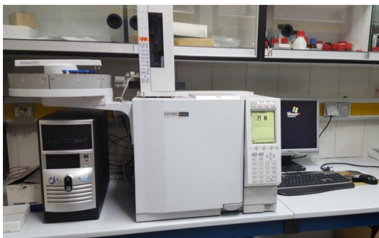
Figura 3.8. GC-FID utilizado para la cuantificación de los reactivos y productos.
