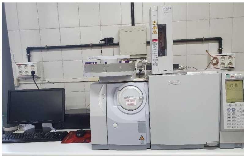
Figura 3.7. GC-MS utilizado para la identificación de los distintos productos de reacción.
