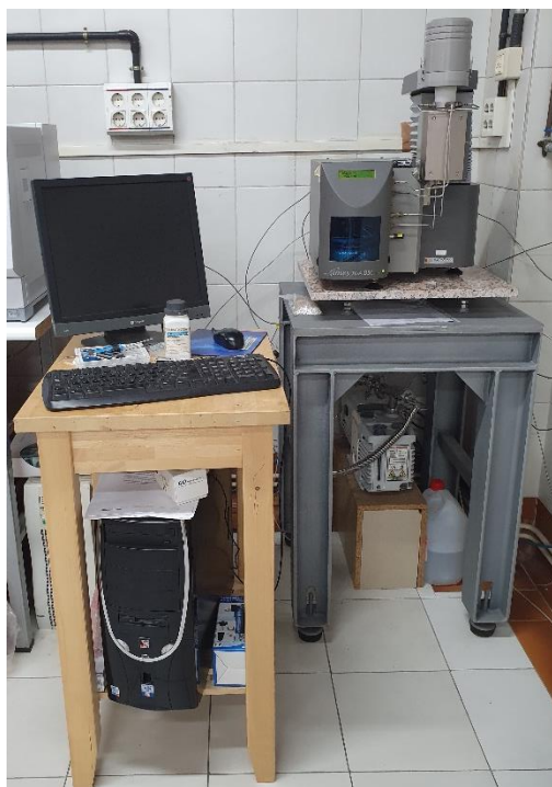
Figura 3.10. Dispositivo experimental del análisis termogravimétrico.
