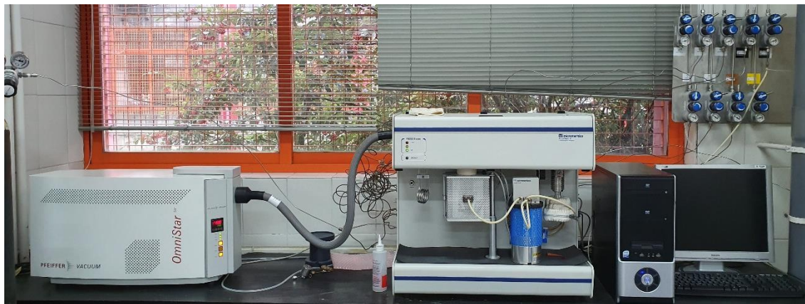
Figura 3.3. Dispositivo experimental para llevar a cabo los experimentos de temperatura programada.
