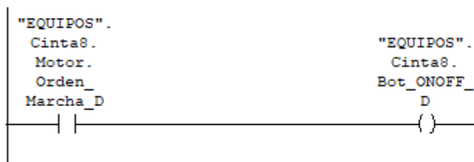
Ilustración 38: Realimentación botón arranque manual CT-08
