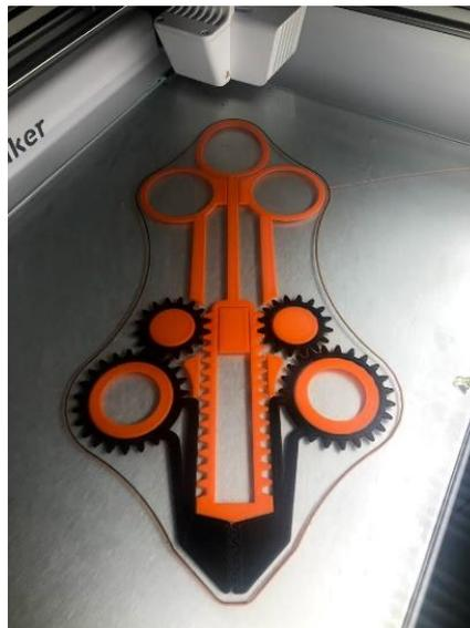
Figura 2-5: Mecanismo fabricado mediante fabricación aditiva [5]
