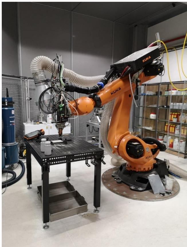
*Figura 3-35: Estación de trabajo Mini-HardFacing (Fuente ArcelorMittal 2020)*
