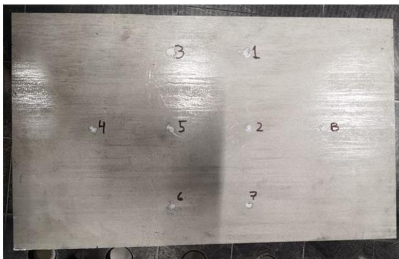
Figura 4-8: Marcado del canal y relleno de los agujeros ciegos de los termopares para el ensayo de calibración (Fuente ArcelorMittal 2020)
