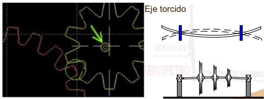
Figura 4. 21. Excentricidad/ Eje doblado
