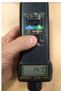
Figura 4. 6. Tacómetro utilizado para realizar las medidas de la velocidad de los ejes
