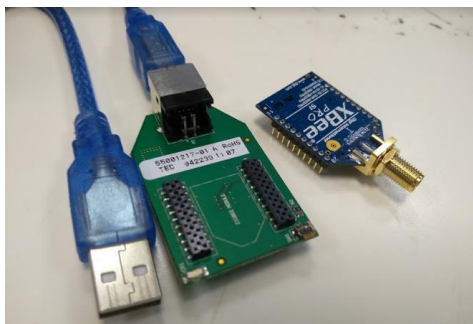
Figura 5. 3. Adaptador USB (la oreja) y el Xbee Pro S1
