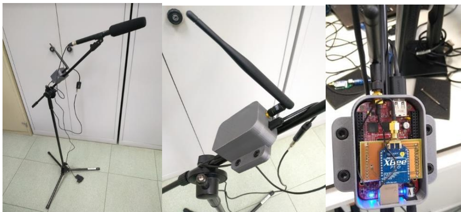
Figura 6. 1. Carcasa para la sujeción del sensor acústico
