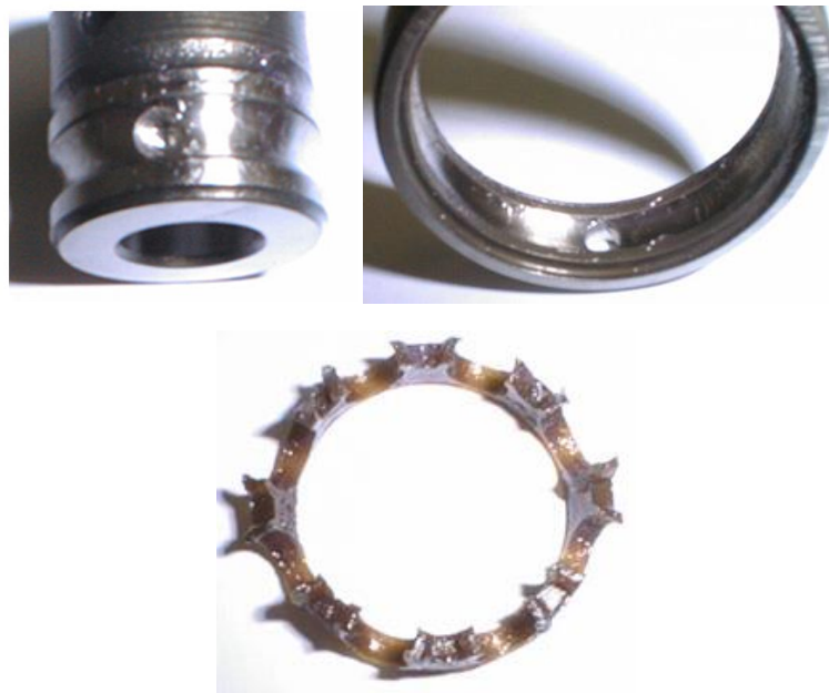
Figura 4. 27. Defectos de tipo BPFI, BPFO, FTF, figuras sacadas de [10,1,26-27].
